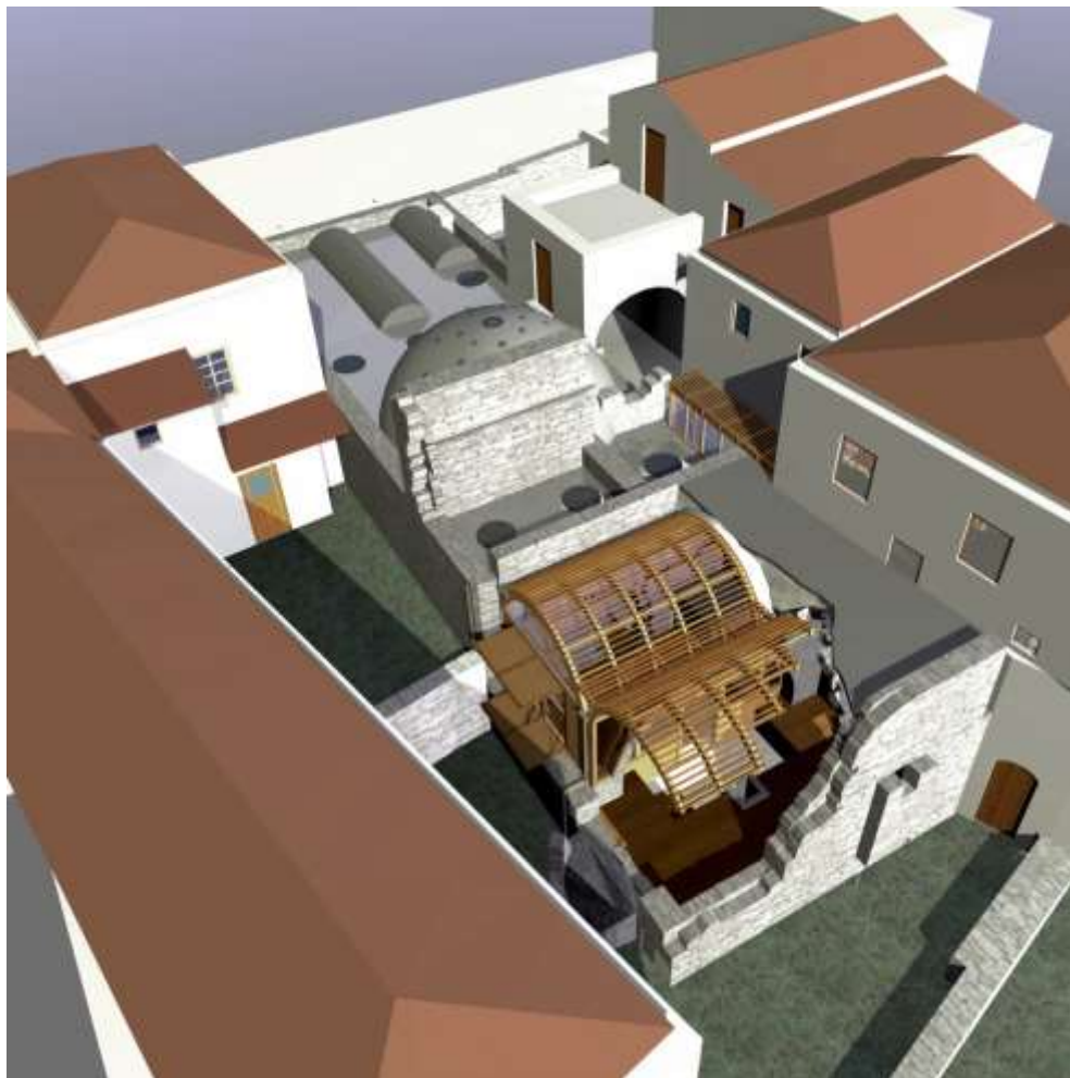
2. Άποψη του λουτρού μετά την επέμβαση από τα νοτιοανατολικά. Χρήση ξύλινων περσίδων.
