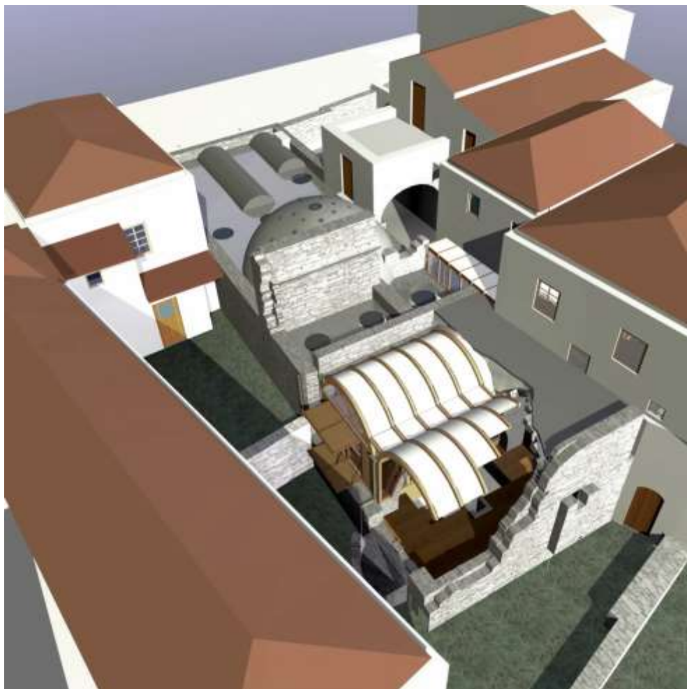
3. Άποψη του λουτρού μετά την επέμβαση από τα νοτιοανατολικά. Χρήση σύνθετων υφασμάτων.
