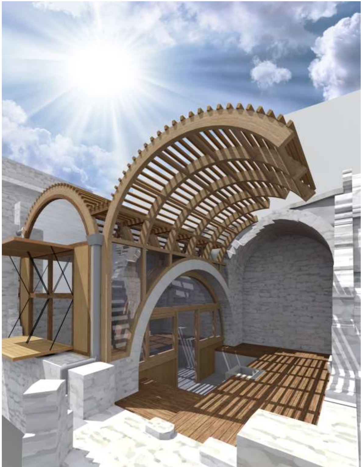
6. Άποψη νέου στεγάστρου από τα νοτιοανατολικά. Χρήση ξύλινων περσίδων.
