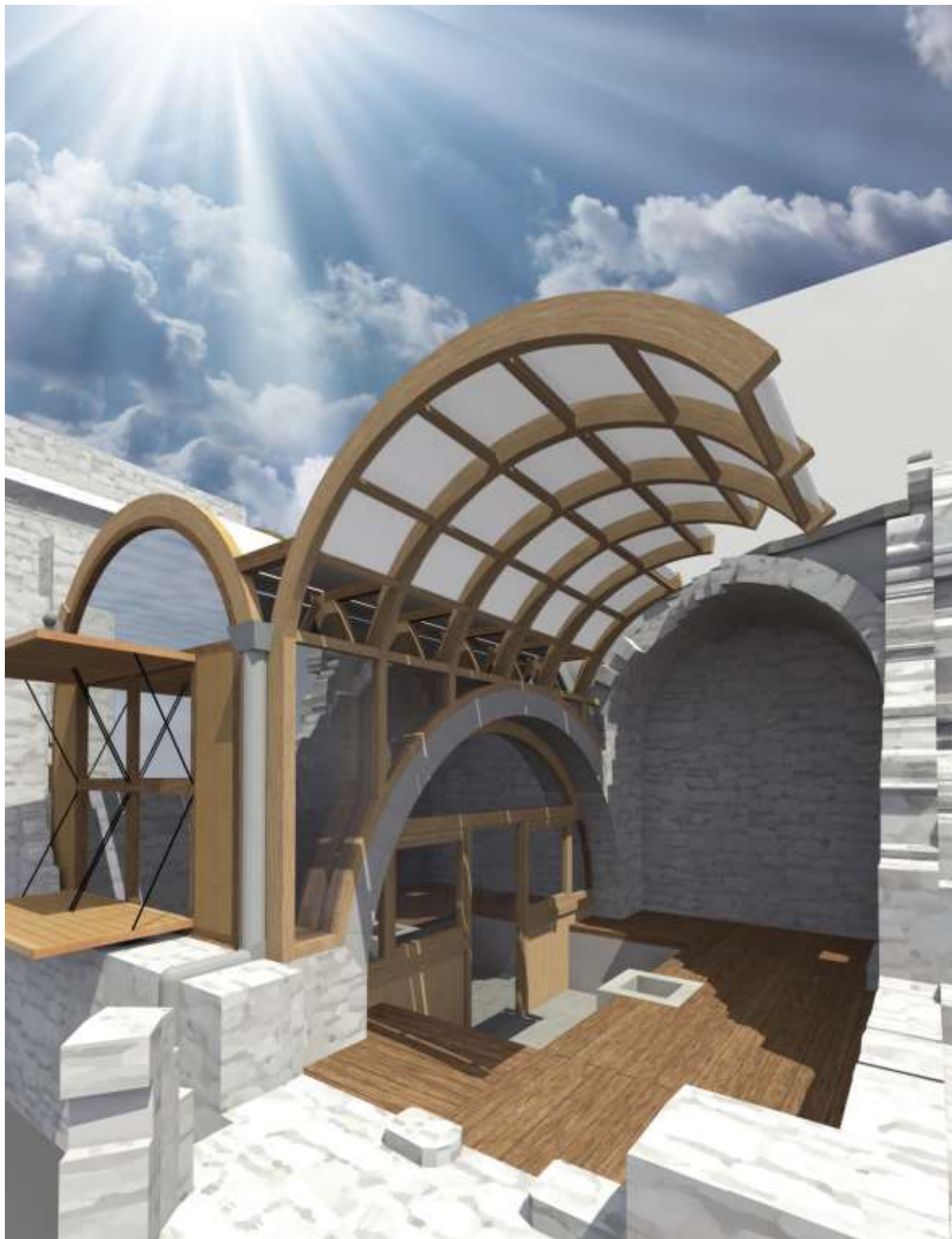
7. Άποψη νέου στεγάστρου από τα νοτιοανατολικά. Χρήση σύνθετων ανθεκτικών υφασμάτων.
