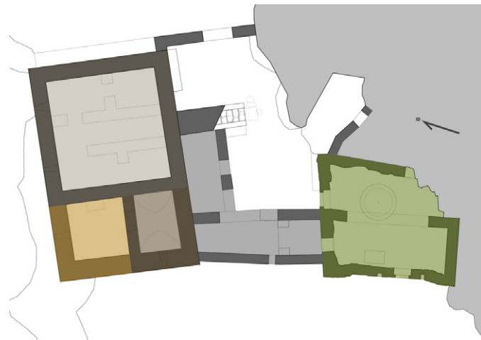
κάτοψη E1 - οικοδομική εξέλιξη συγκροτήματος
