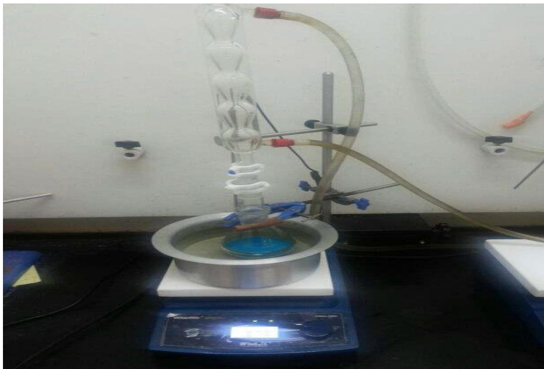
Εικόνα 1. Διάταξη θέρμανσης των κρυστάλλων συνδεδεμένη με συμπυκνωτήρα.
