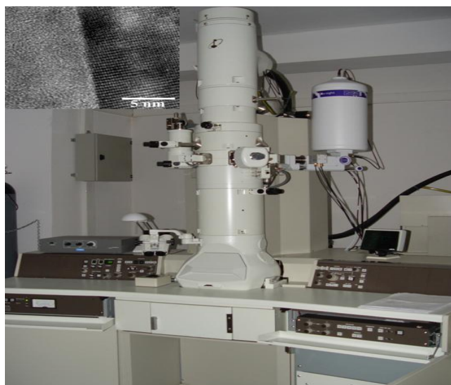
Εικόνα 2.3.4.: Ηλεκτρονικό μικροσκόπιο διέλευσης υψηλής διακριτικής ικανότητας.
