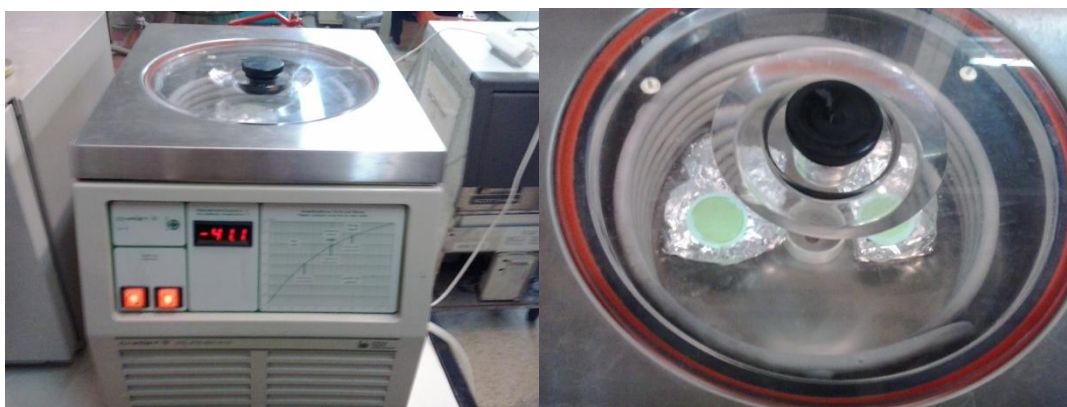
Εικόνα 14: Συσκευή λυοφιλίωσης και θάλαμος κενού της συσκευής
