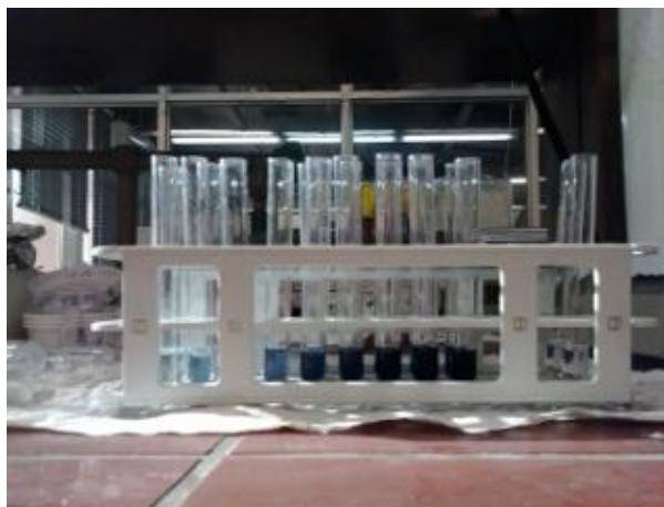
Εικόνα 15: Προσδιορισμός πρωτεϊνών με τη μέθοδο Lowry
