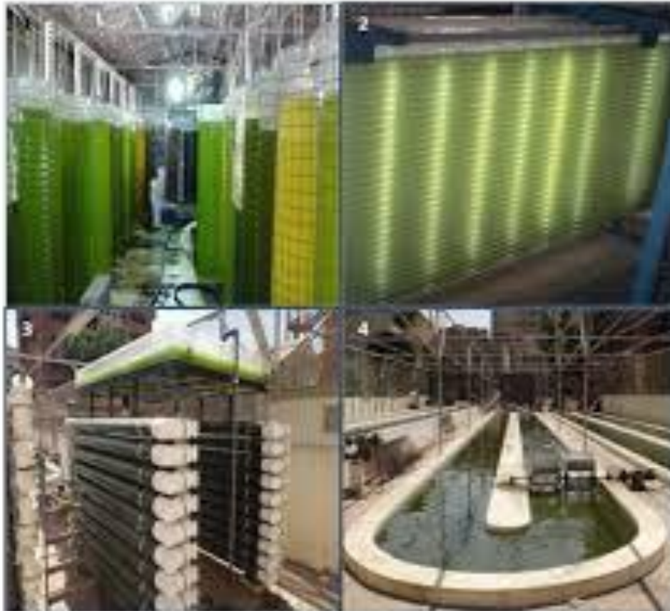
Εικόνα 7: Διάφοροι τύποι συστημάτων καλλιέργειας μικροφυκών: (1) Πλαστικοί σάκοι 300 λίτρων, (2) επίπεδοι φωτοαντιδραστήρες, (3) οριζόντιοι σωληνωτοί φωτοαντιδραστήρες και (4) ανοικτή δεξαμενή τύπου raceway
