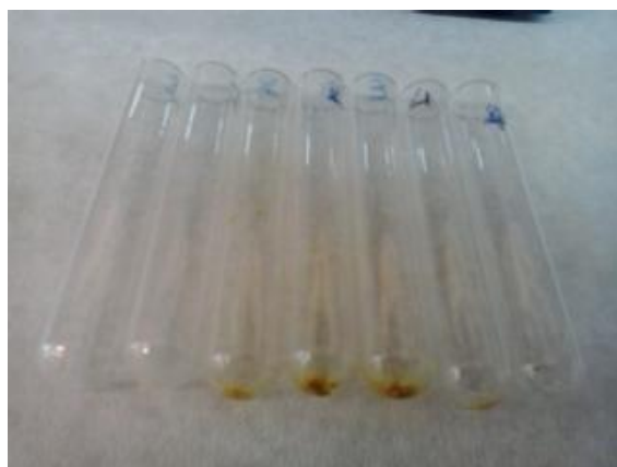
Εικόνα 17: Παραλαβή λιπαρών μετά την εξάτμιση του διαλύτη εκχύλισης
