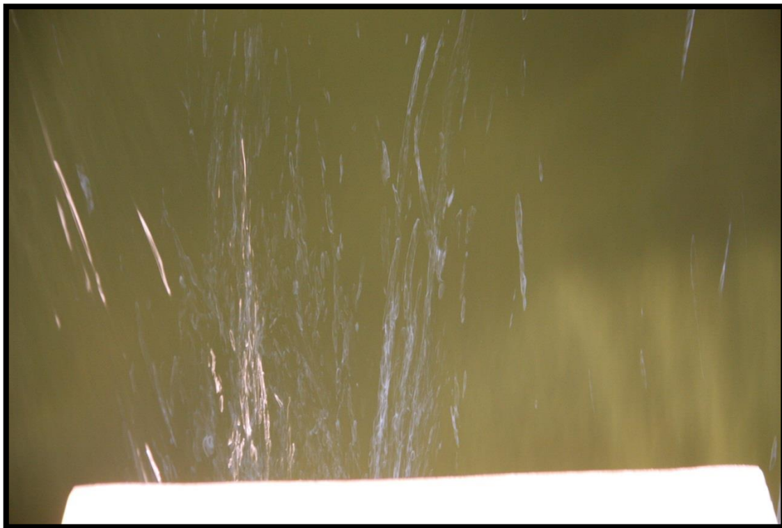
Εικόνα : Ροή στην πρύμνη για F_n=0,146
