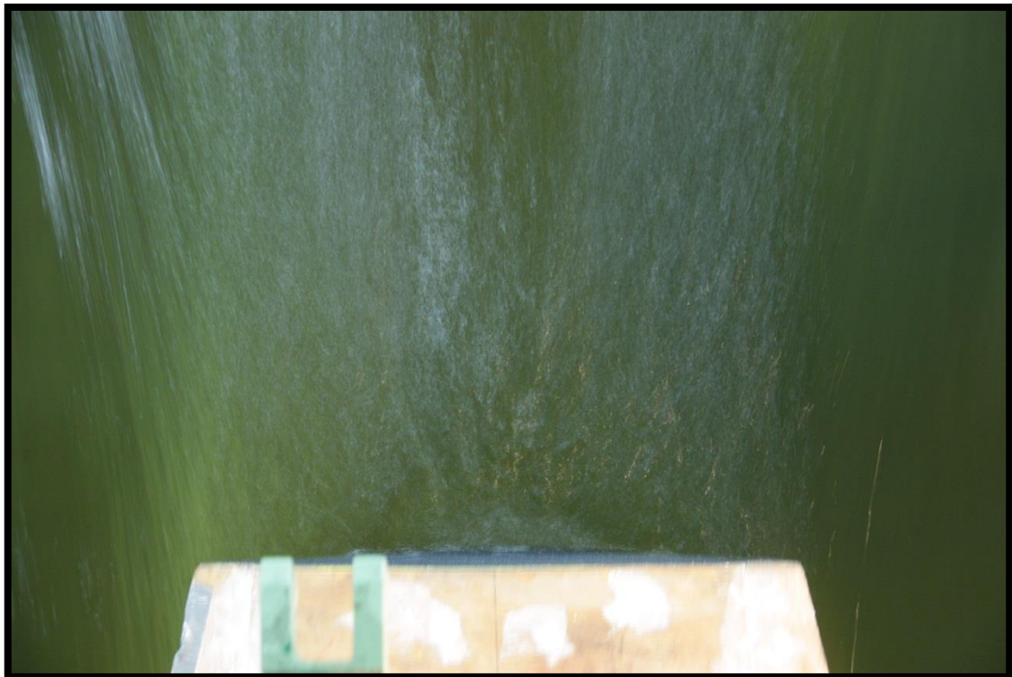
Εικόνα : Ροή στην πρύμνη για F_n=0,193
