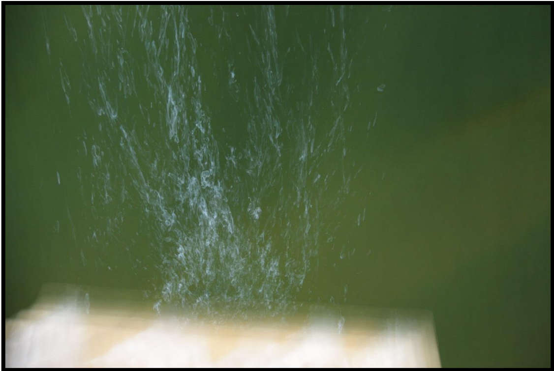
Εικόνα : Ροή στην πρύμνη για Fn=0,146
