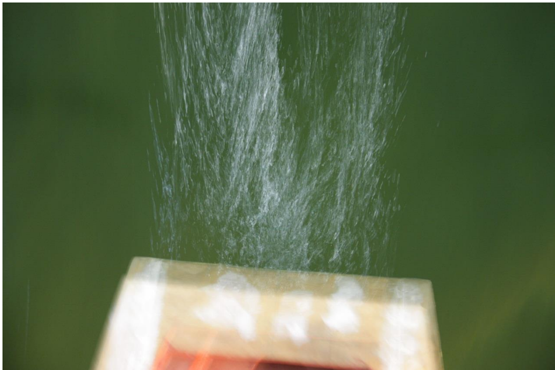
Εικόνα : Ροή στην πρύμνη για Fn=0,17
