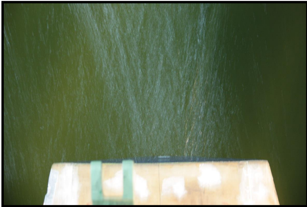
Εικόνα : Ροή στην πρύμνη για F_n=0,193
