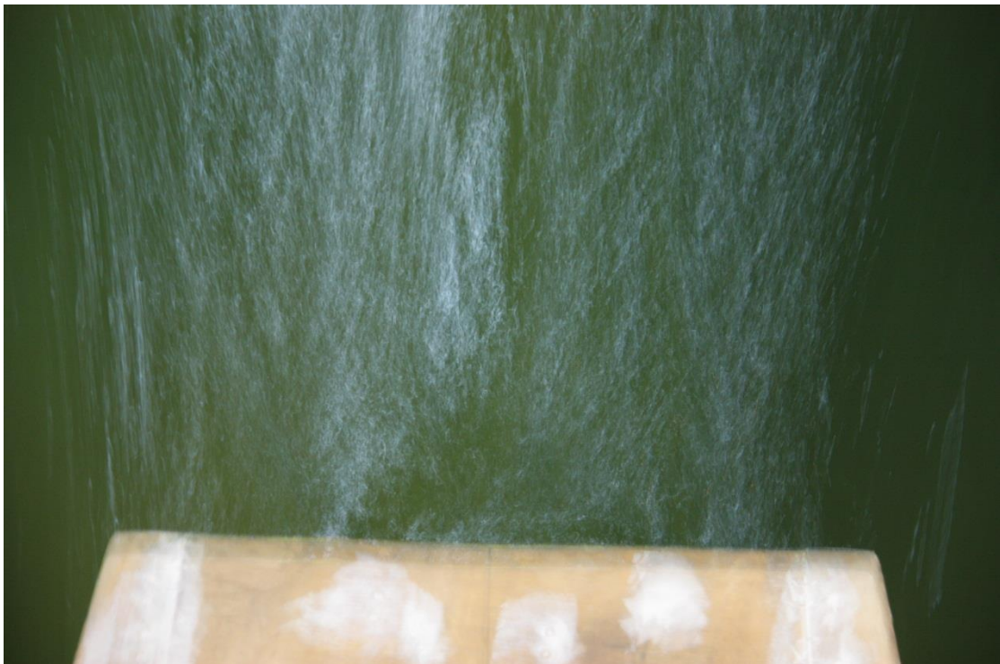
Εικόνα : Ροή στην πρύμνη για F_n=0,193
