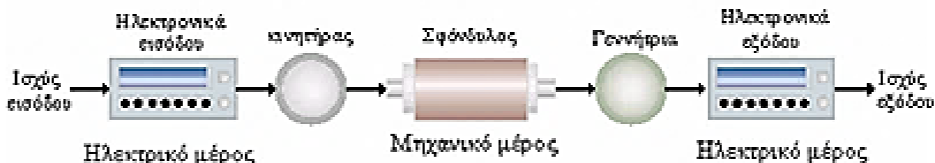
Εικόνα 1.10: Αρχή λειτουργίας του συστήματος Flywheel [16]
