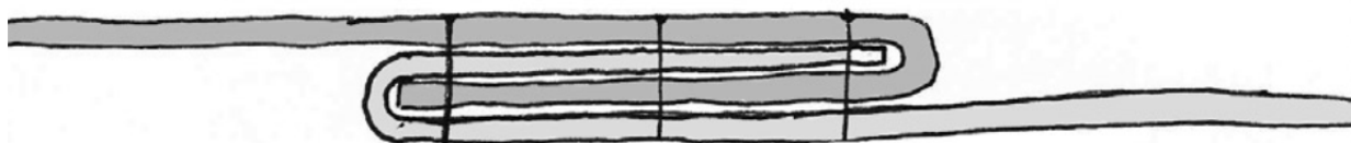
Σχ. 5.43 Σκίτσο ραφών: Διπλής υποστήριξης
