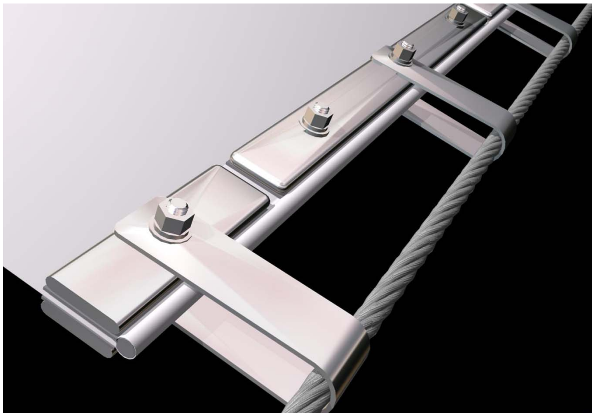
Σχ. 6.3. Ελάσματα σύσφιξης και πάνω και κάτω στην μεμβράνη
