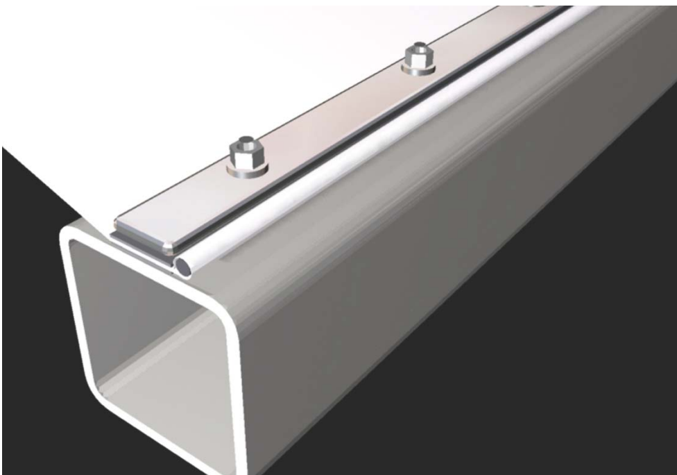
Σχ.6.7. Συγκράτηση σε κοίλη ορθογωνική δοκό
