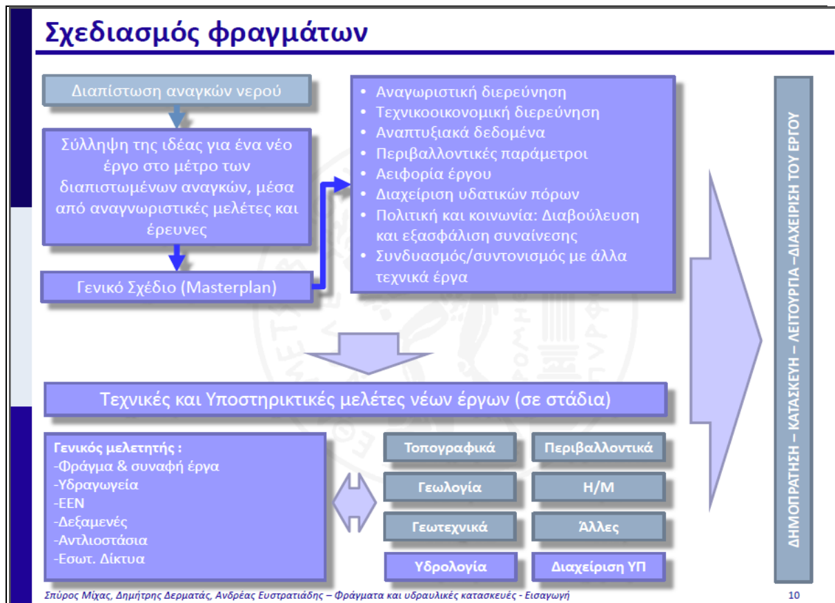
Εικόνα 37 : Πίνακας σχεδιασμού φραγμάτων
