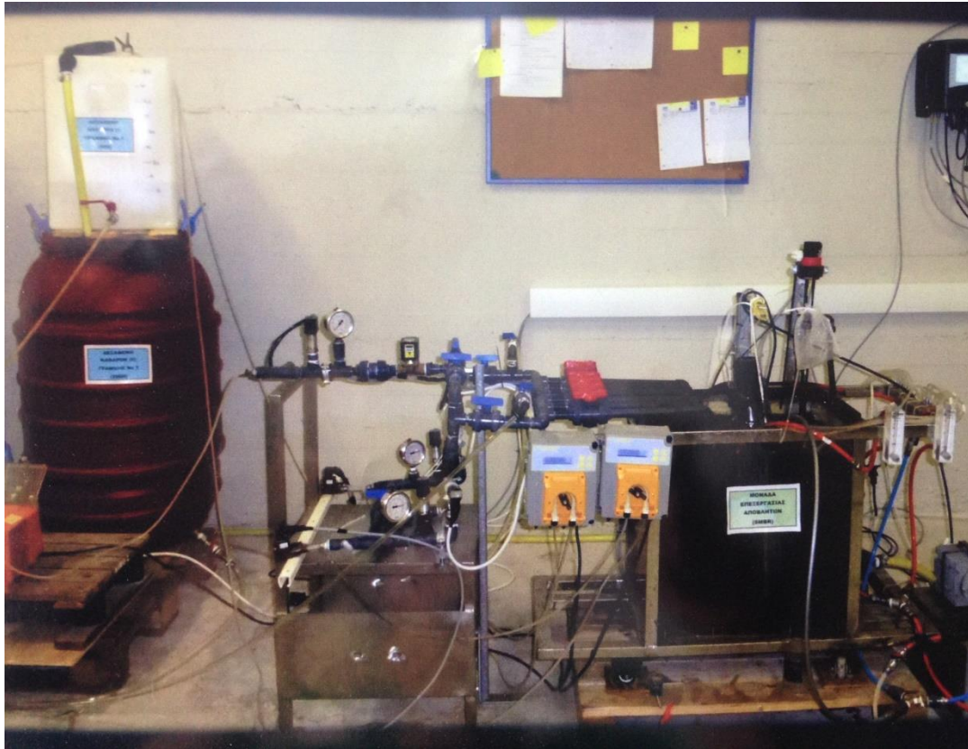
Εικόνα 1 Πιλοτική διάταξη μονάδας MBR
