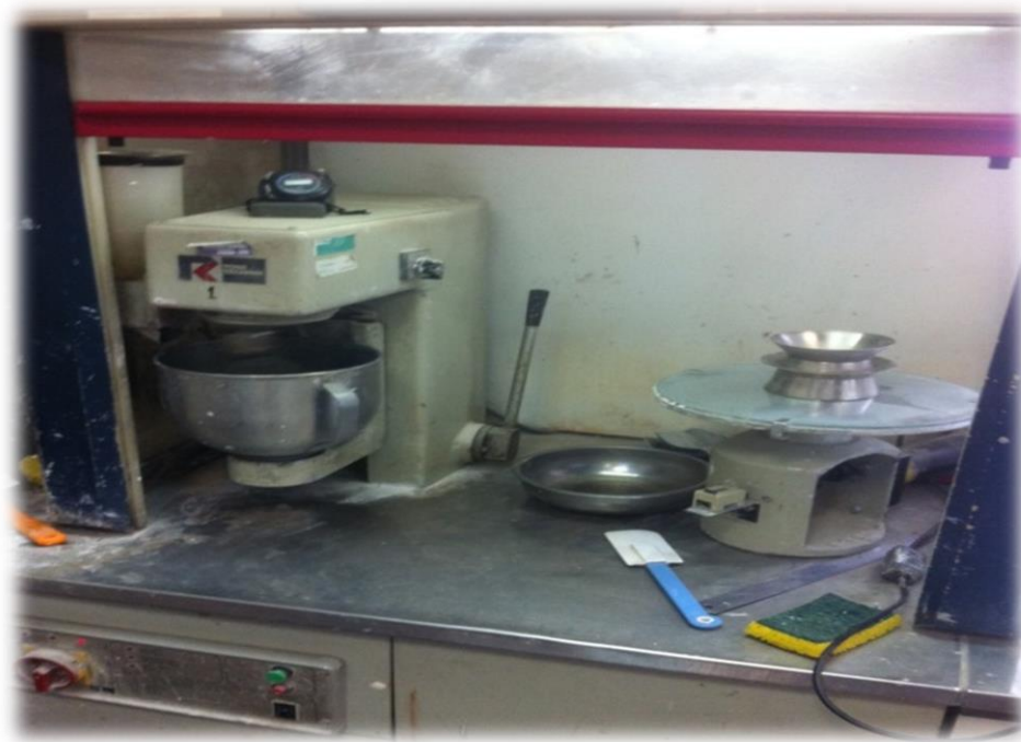
Εικόνα 2.13 Από αριστερά προς τα δεξιά: Μίξερ παρασκευής κονιάματος – Ηλεκτρονικό χρονόμετρο - Πλαστικό ξέστρο - Τράπεζα εξάπλωσης.
