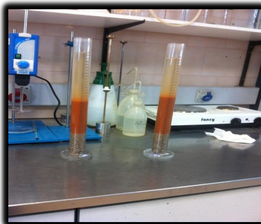
Εικόνα 2.10 Ογκομετρικοί κύλινδροι σε κατάσταση ηρεμίας στο πάγκο εργασίας. Αριστερά: δείγμα αργιλοπυριτικού αναμίγματος. Δεξιά: ασβεστολιθικού αναμίγματος.
