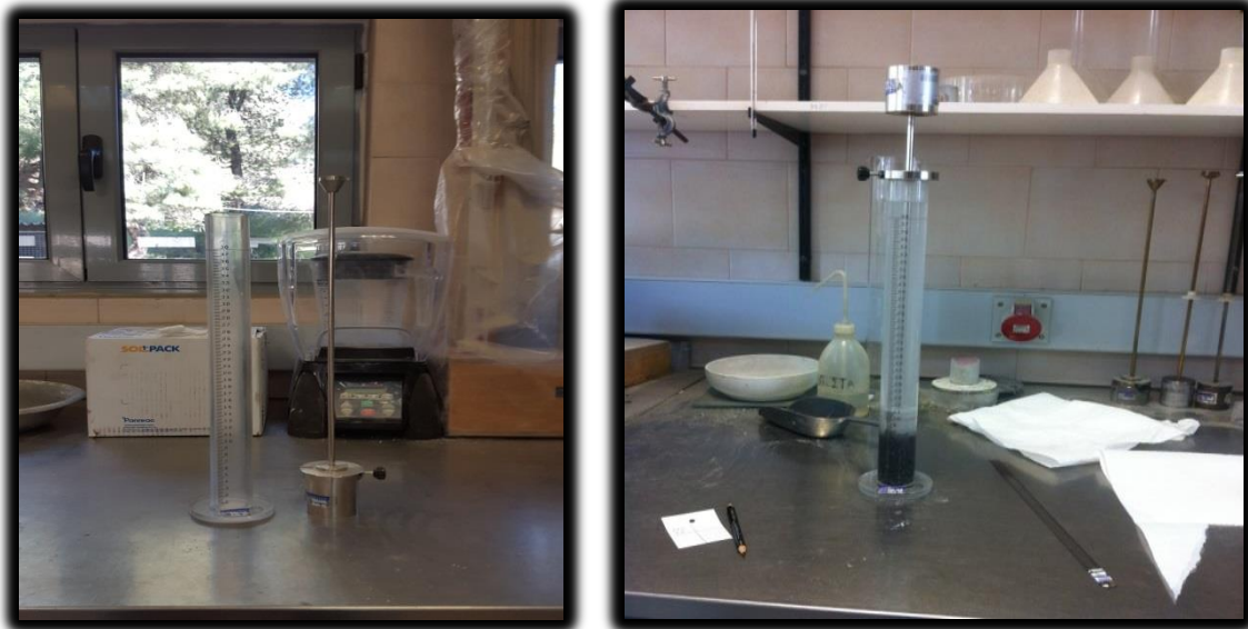
Εικόνα 2.11 Εφαρμογή διάταξης βάρους με κολάρο σε ογκομετρικό κύλινδρο.
