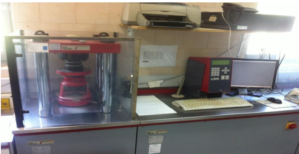
Εικόνα 2.7 Μηχανική υδραυλική πρέσα της Toni Technik (Baustoffprüfsysteme), συνδεδεμένη με το απαραίτητο λογισμικό.
