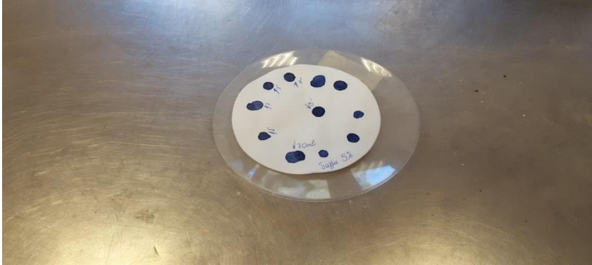
Εικόνα 2.12 Διηθητικό φίλτρο επάνω σε επιφάνεια υάλου ωρολογίου. Οι φερόμενες μπλε κηλίδες επί του διηθητικού φίλτρου έχουν σχηματιστεί από απόθεση σταγόνων με τη βοήθεια γυάλινης ράβδου.
