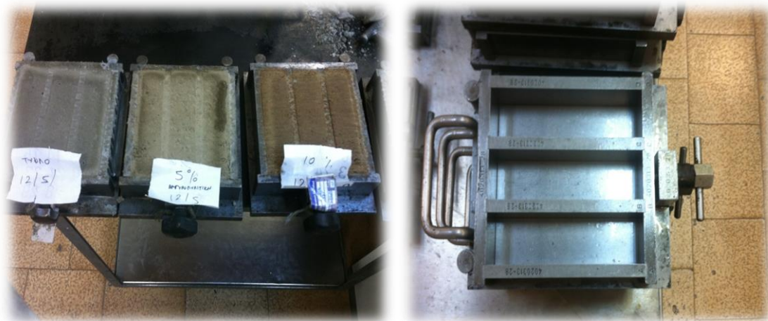
Εικόνα 2.14 Μήτρες παρασκευής πρισματικών δοκιμίων διαστάσεων (40mm x 40mm x 160mm).
