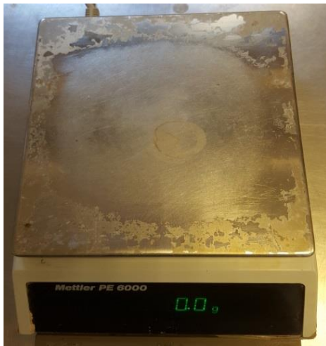
Εικόνα 2.4 Ηλεκτρονικός ζυγός Mettler PE 6000 ακρίβειας ενός δεκαδικού ψηφίου.
