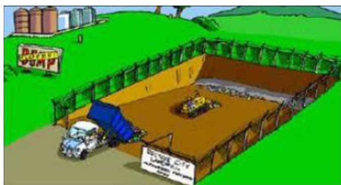
Σχήμα 13: Εναπόθεση απορριμμάτων με τη μέθοδο διαδοχικών τάφρων [13]
