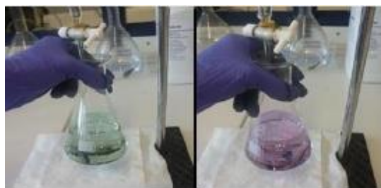
Εικόνα 71: Μετά την απόσταξη και πριν την τιτλοδότηση (αριστερά) και μετά την τιτλοδότηση (δεξιά)
