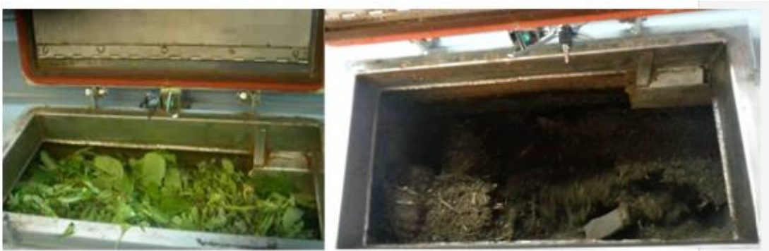
Εικόνα 38: Εισερχόμενο υλικό στο εσωτερικό του συστήματος GAIA (κάτω), Ξηραμένο υλικό (πάνω) στο εσωτερικό του ίδιου συστήματος
