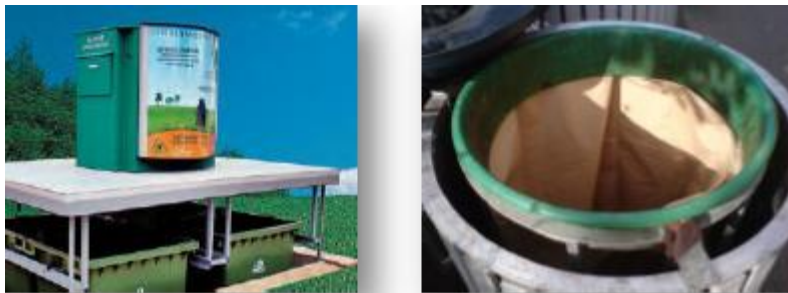
Εικόνα 21: Υπόγειο σύστημα κάδων συλλογής οικιακών βιοαποβλήτων με κάδους (αριστερά), σακούλα (δεξιά) [19]
