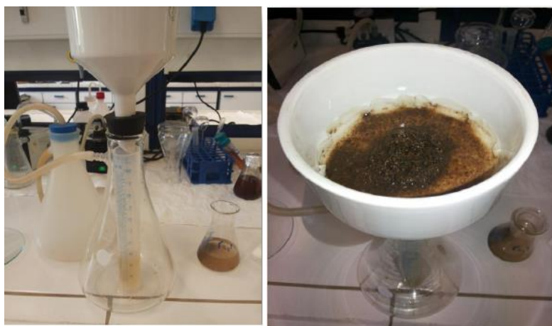
Εικόνα 57: Συλλογή υγρού στον ογκομετρικό κύλινδρο (αριστερά) και συγκράτηση στερεού εκχυλίσματος στο διηθητικό χαρτί (δεξιά)
