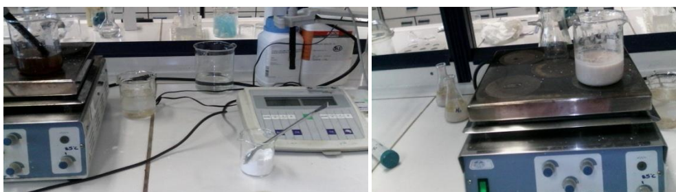
Εικόνα 66: Αρχή της εξουδετέρωσης του δείγματος με \text{CaCO}_3 (αριστερά) και εξουδετερωμένο δείγμα σε pH=5-5,5 (δεξιά)
