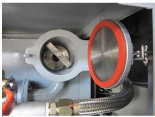
Εικόνα 42: Φίλτρο κατακράτησης οσμών και σωματιδίων του συστήματος GAIA
