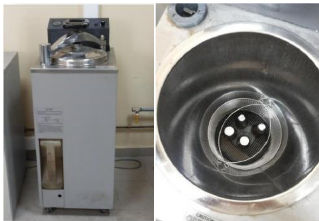
Εικόνα 65: Συσκευή αποστείρωσης (αριστερά) και κωνικές φιάλες στο εσωτερικό της για αποστείρωση στους 121°C (δεξιά)
