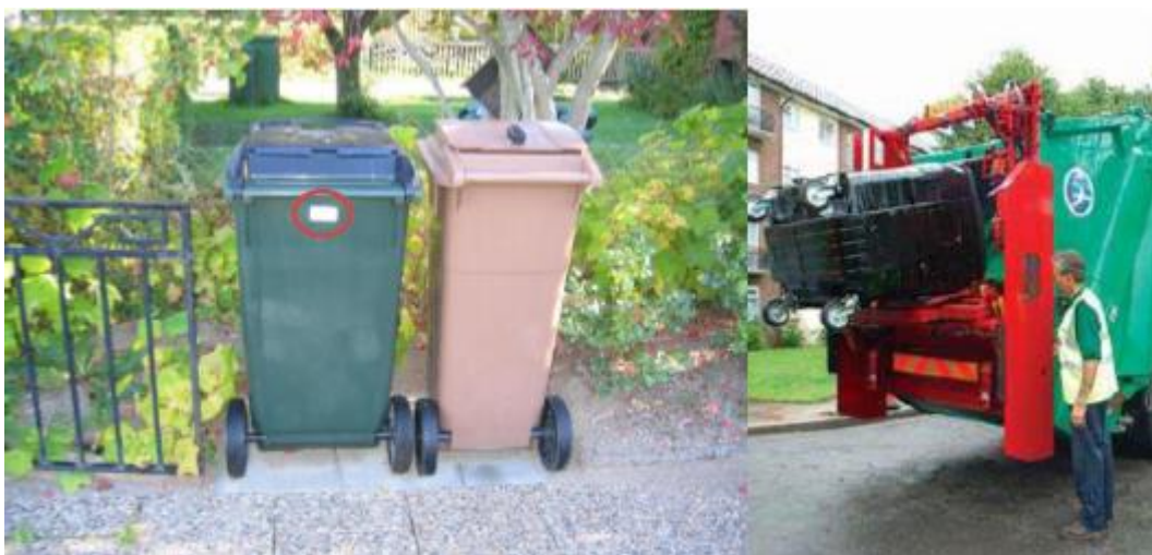
Εικόνα 12: Κάδοι συλλογής βιοαποβλήτων τοποθετημένοι στο εξωτερικό οικίας στη Στοκχόλμη με ειδικό barcode καταγραφής της οικίας (αριστερά), απορριματοφόρο με σύστημα ζύγισης (δεξιά) [19]
