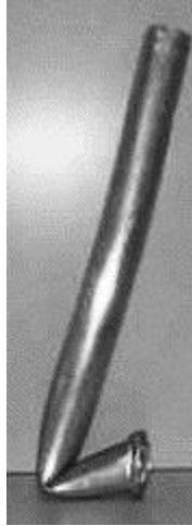
Σχήμα 2.6: Δοκίμιο που έχει μεταβεί από προοδευτική κατάρρευση σε λυγισμό [6]
