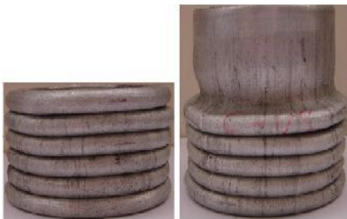
Σχήμα 2.2: Αξονοσυμμετρικός τρόπος κατάρρευσης.
