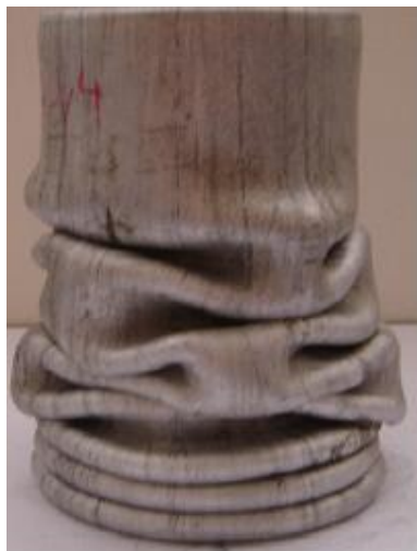
Σχήμα 2.5: Μεικτός τρόπος κατάρρευσης [5]
