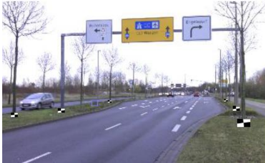
Εικόνα 2.14 Εξωτερικό πεδίο λήψης με τοποθετημένους τεχνητούς στόχους. [V10 technical overview]
