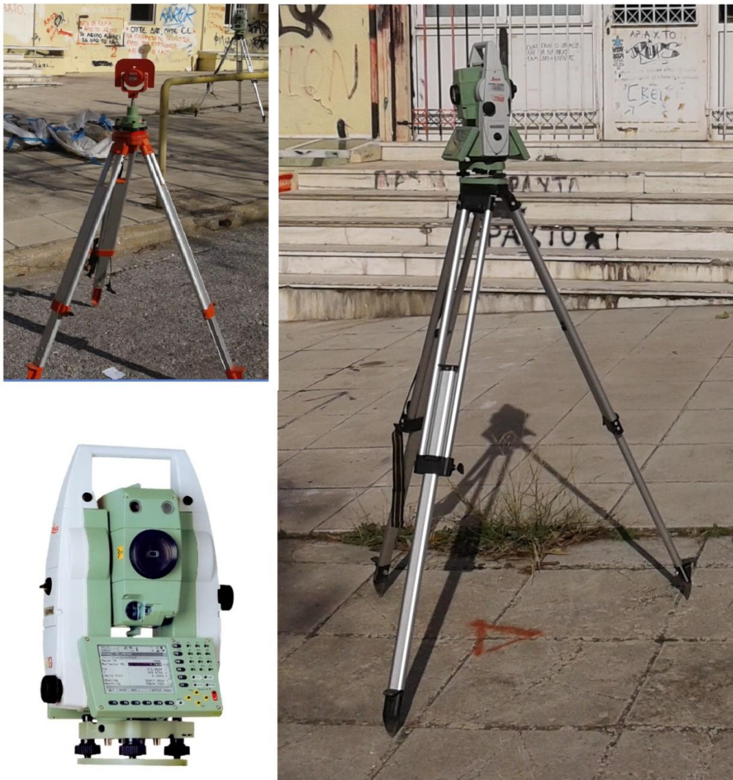
Εικόνα 4.2 Ολοκληρωμένος γεωδαιτικός σταθμός TPS 1201+ της εταιρείας Leica κατά τις εργασίες υπαίθρου.
