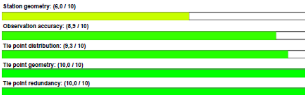
Εικόνα 4.5 Μπάρες βαθμολόγησης της χειροκίνητης επίλυσης του τριγωνισμού για την αποτύπωση της όψης του Λαμπαδαρίου.
