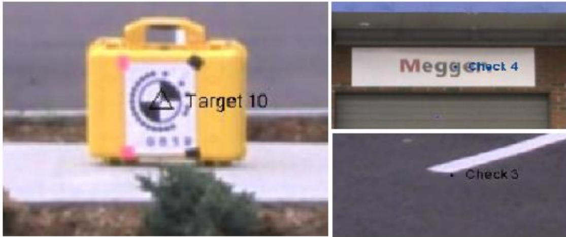
Εικόνα 2.15 Σημεία ελέγχου τριγωνισμού του V10. [V10 technical overview]
