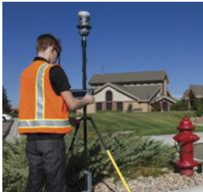
Εικόνα 2.2 Το σύστημα V10 σε σύζευξη με τον επιβατηγό δέκτη GNSS R10. [trimble v10 imaging rover user applications brochure]
