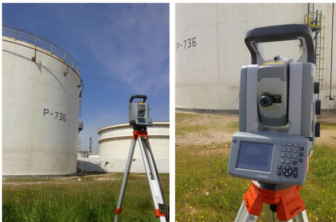
Εικόνα 4.12 Ο χωροεικονογεωδαιτικός σταθμός VX κατά τη σάρωση.
