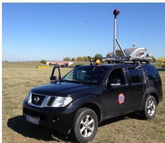
Εικόνα 1.3 Η πανοραμική μηχανή Ladybug 5 της εταιρεία Topcon, μόνη της και σε επανδρωμένο όχημα τριδιάστατης χαρτογράφησης. [ http://www.directionsmag.in/articles/georeferenced-street-view-what-it-is-and-how-to-create-one/362196 , 9/2015]
