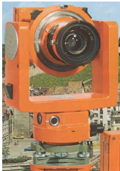
Εικόνα 1.2 Φωτοθεοδόλιχο P31 της εταιρείας Wild με έτος κυκλοφορίας 1972. [ http://www.wild-heerbrugg.com/photogrammetry1.htm , 9/2015]
