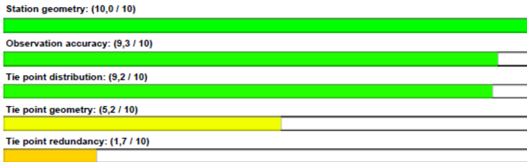
Εικόνα 4.15 Μπάρες βαθμολόγησης από την τελική επίλυση του επίγειου τριγωνισμού στο TBC για την αποτύπωση της δεξαμενής P-7836.
