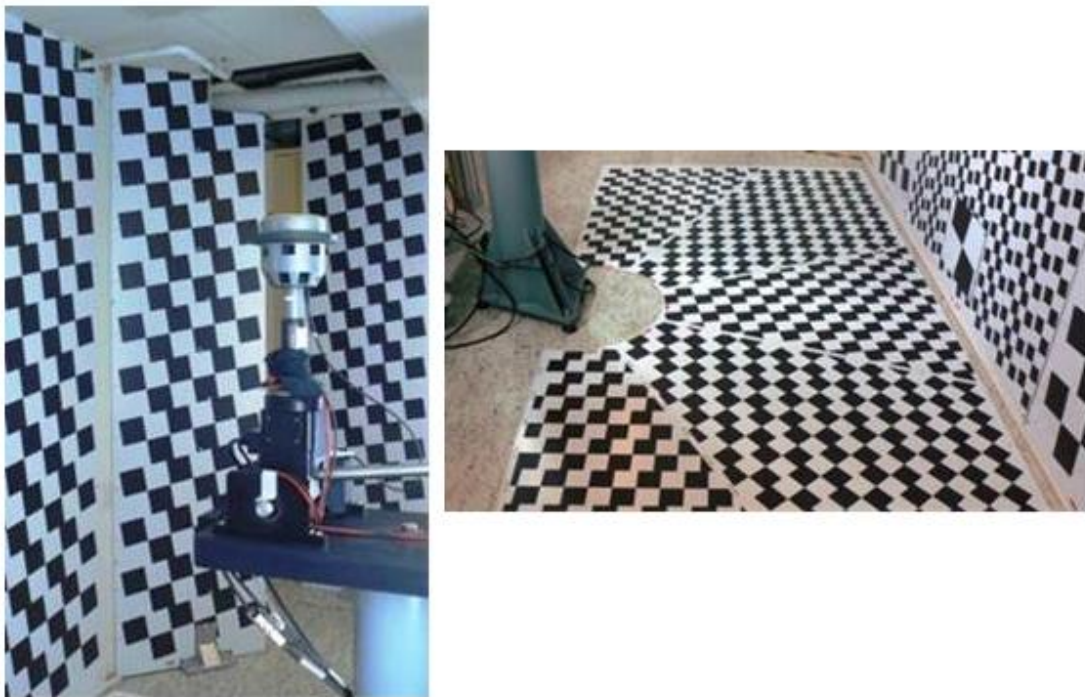
Εικόνα 3.2 Θάλαμος βαθμονόμησης του συστήματος τριδιάστατης απεικόνισης V10. [ http://www.neigps.com/news/trimble-v10-tech-tips-part-12/ ]
