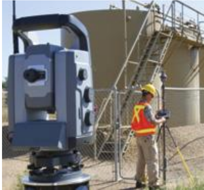
Εικόνα 2.1 Το σύστημα V10 σε σύζευξη με το χωροεικονογεωδαιτικό σταθμό VX σε λειτουργία autolock. [trimble v10 imaging rover user applications brochure]
