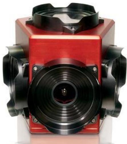
Εικόνα 1.3 Η πανοραμική μηχανή Ladybug 5 της εταιρεία Topcon, μόνη της και σε επανδρωμένο όχημα τριδιάστατης χαρτογράφησης. [ http://www.directionsmag.in/articles/georeferenced-street-view-what-it-is-and-how-to-create-one/362196 , 9/2015]
