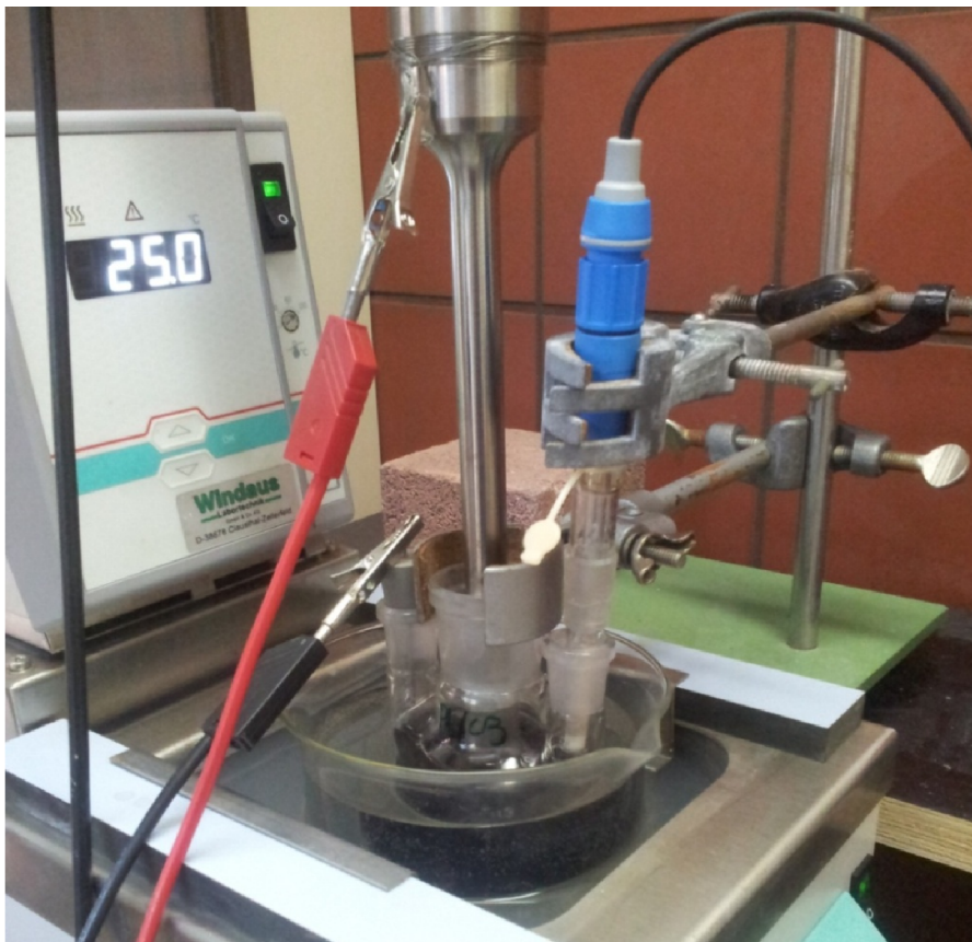
Εικόνα 33. Απεικόνιση συνδεσμολογίας στην διάταξη με τρίλαιμη σφαιρική φιάλη και θερμοστατικό λουτρό
