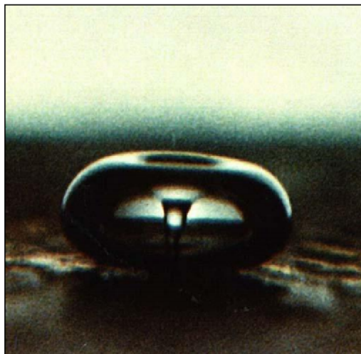
Εικόνα 5. Καταρρέουσα φυσαλίδα σπηλαιώσης στην περιοχή επιφάνειας
