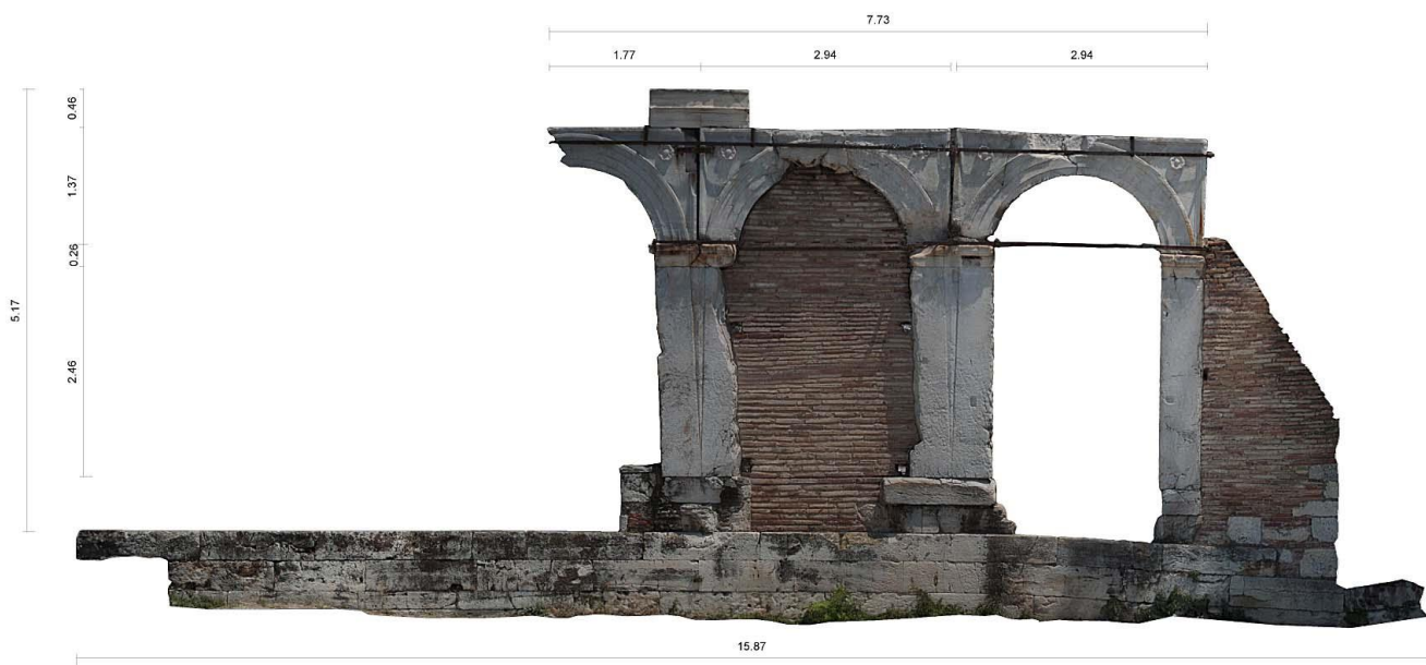
Εικ.73 , Ορθοφωτογραφία της δυτικής όψης του δυτικού τοίχου
