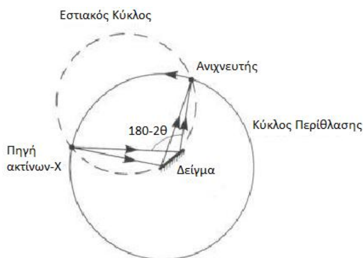
Σχήμα 5.3: Γεωμετρική διάταξη Bragg – Brentano για περίθλαση ακτίνων X [70].
