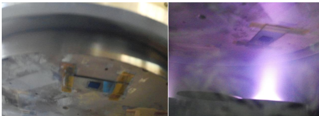
Σχήμα 6.2: (αριστερά) Η τοποθέτηση του δείγματος στο σύστημα του sputtering με χρήση κολλητικής ταινίας. (δεξιά) Εικόνα που λήφθηκε κατά τη διάρκεια της εναπόθεσης. Στο κάτω μέρος διακρίνεται ο στόχος, στο πάνω μέρος διακρίνεται το υπόστρωμα και στη μέση διακρίνονται τα άτομα που στόχου που έχουν αποκολληθεί και κατευθύνονται στο υπόστρωμα προς απόθεση.
