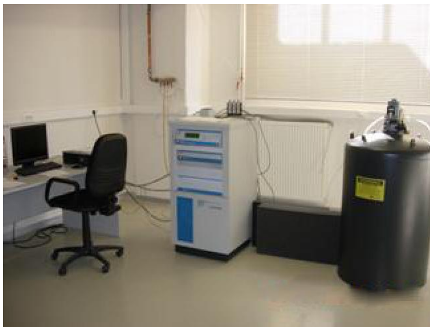
Σχήμα 5.10: Το Σύστημα Μετρήσεων Φυσικών Ιδιοτήτων που χρησιμοποιήθηκε για τα δείγματα της εργασίας. Αριστερά φαίνεται η κονσόλα ελέγχου και δεξιά το σύστημα του κρυοστάτη που περιλαμβάνει τον υπεραγωγό μαγνήτη και τη ράβδο που φέρει το δείγμα.
