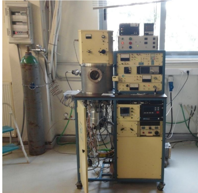
Σχήμα 6.1: Το σύστημα sputtering που χρησιμοποιήθηκε για την παρασκευή των δειγμάτων μας.
