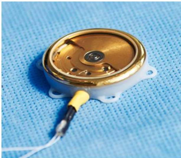
Εικόνα 3-19: Συσκευή συγκομιδής ενέργειας - MIOG [43]
