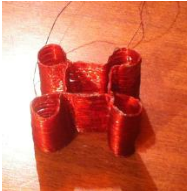
Εικόνα 5-10: Τύλιγμα με 4 παράπλευρους βρόχους διαμέτρου 7mm
