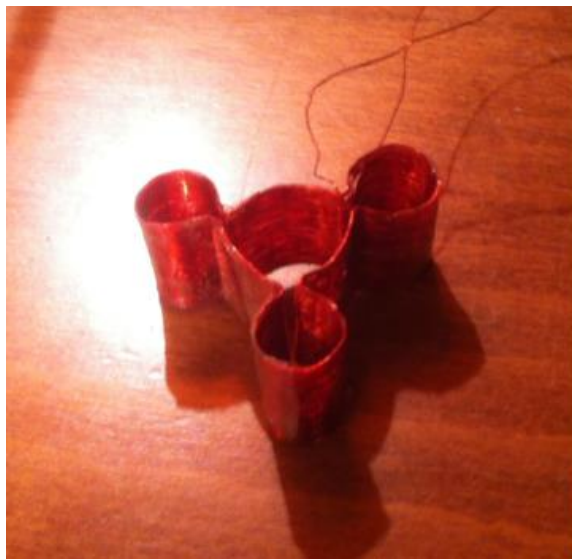
Εικόνα 5-12: Τύλιγμα με 3 παράπλευρους βρόχους διαμέτρου 10mm
