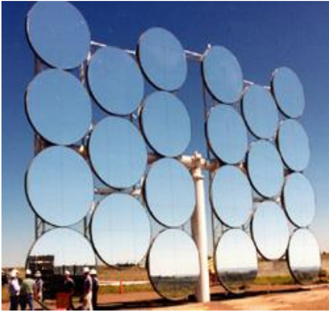
Σχήμα 3.15 Μοντέλα ηλιοστατών σε πειραματικό στάδιο : αριστερά της εταιρείας SAIC, δεξιά το μοντέλο Stellio της εταιρείας Schlaich Sergermann und Partner (Πηγή : «Large-Scale Solar Thermal Power Plants». Werner Vogel, Henry Calb)
