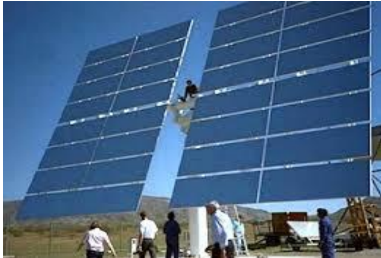
Σχήμα 3.13 Τυπικός σχεδιασμός ηλιοστάτη με κενά (Πηγή : http://www.solarpaces.org/ )
