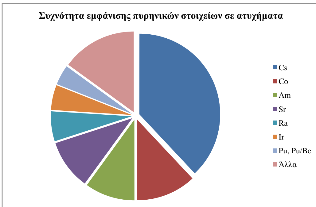
Εικόνα 4: Η σχετική συχνότητα με την οποία τα διάφορα πυρηνικά στοιχεία συμμετέχουν σε πυρηνικά ατυχήματα. Είναι εμφανής η υπεροχή του ^{137}\text{Cs} . (8)
