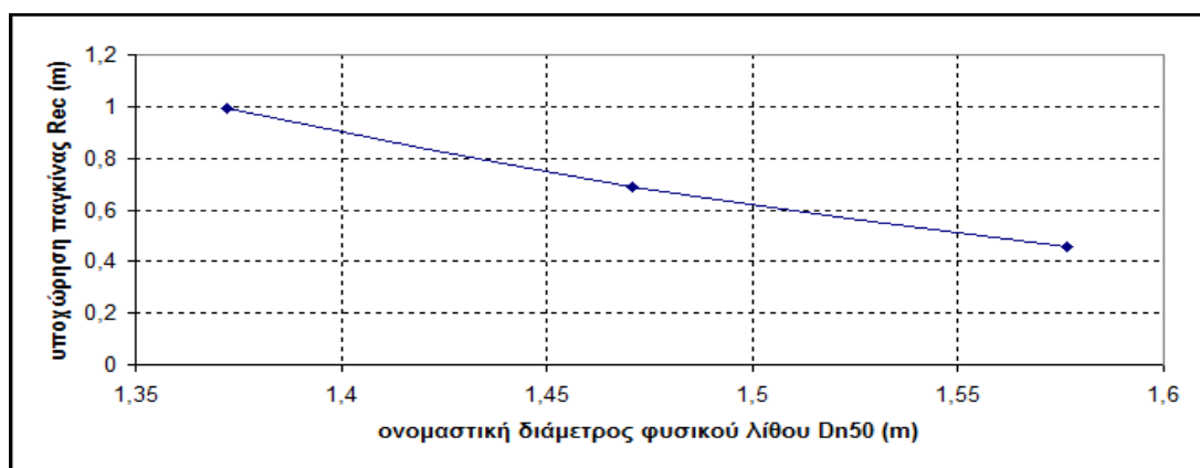
Σχήμα 5.28: Αναλογία διαστάσεων φυσικού λίθου και υποχώρησης αναβαθμού στη διατομή με αναβαθμό που υπολογίστηκε
