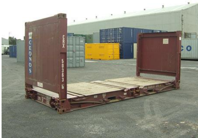
Σχήμα 29: Εμπορευματοκιβώτιο τύπου Flat rack βάρους περίπου 5 τόνων, για τη πραγματοποίηση ειδικών μεταφορών
