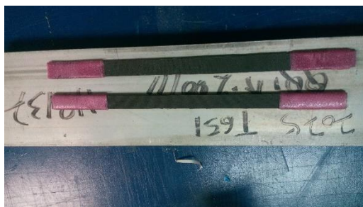
Εικόνα 4-15: Προετοιμασία των άκρων των δειγμάτων για την πραγματοποίηση των δοκιμών εφελκυσμού
