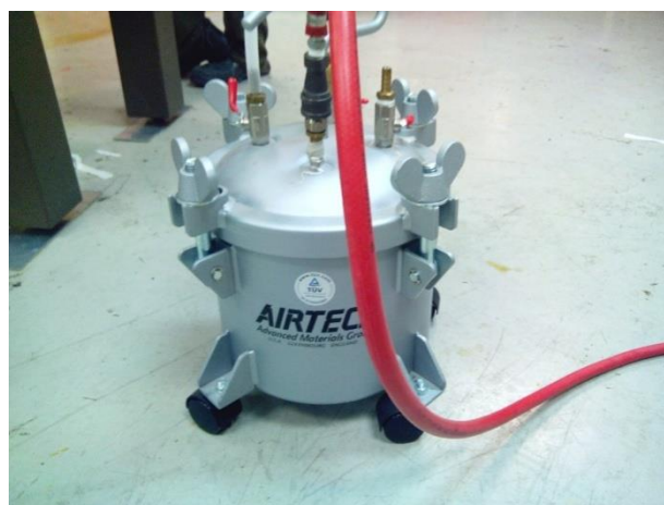
Εικόνα 4-10: Συσκευή για την διατήρηση του κενού και τον έλεγχο ροής της εποξειδικής ρητίνης στη διάταξη εγχυσης
