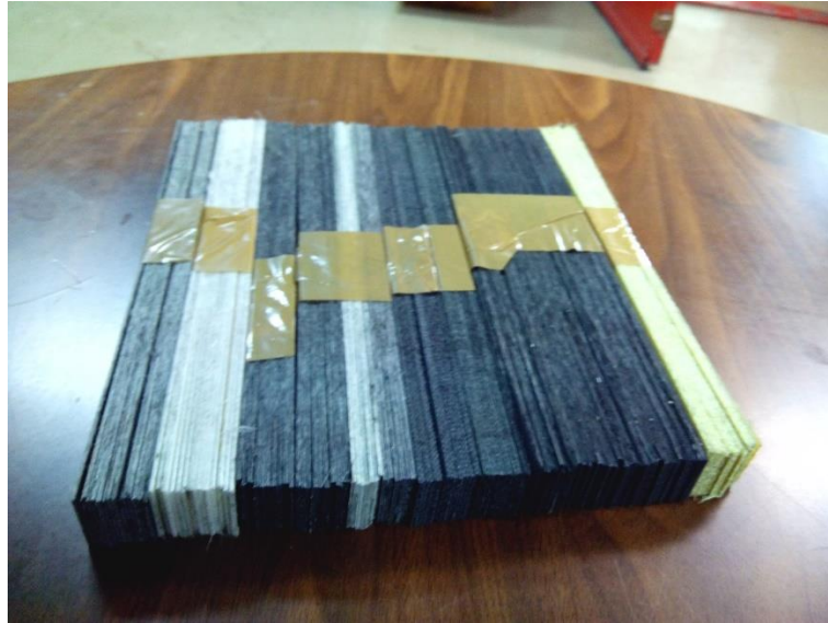
Εικόνα 4-12: Δείγματα σύνθετων υλικών που κατασκευάστηκαν, κομμένα σε λωρίδες
