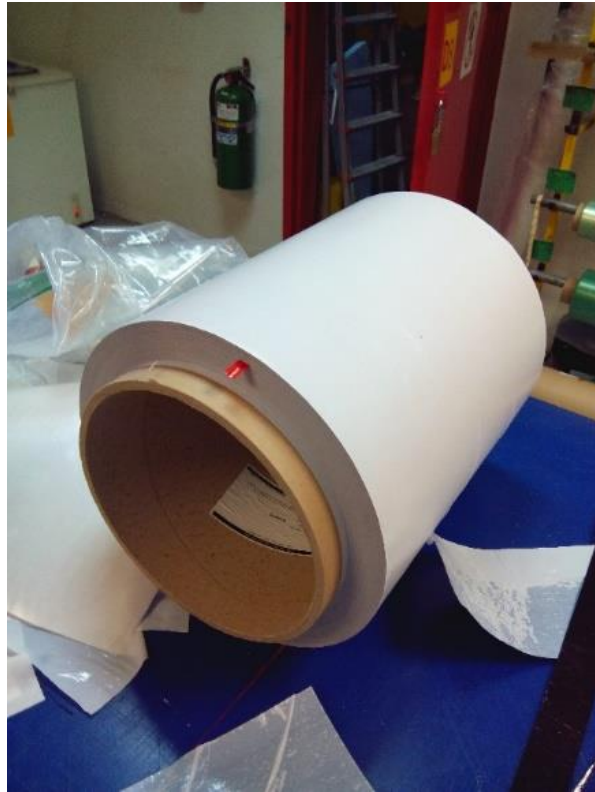
Εικόνα 4-1: Προεμποτισμένο φύλλο γυαλιού εποξειδικής ρητίνης
