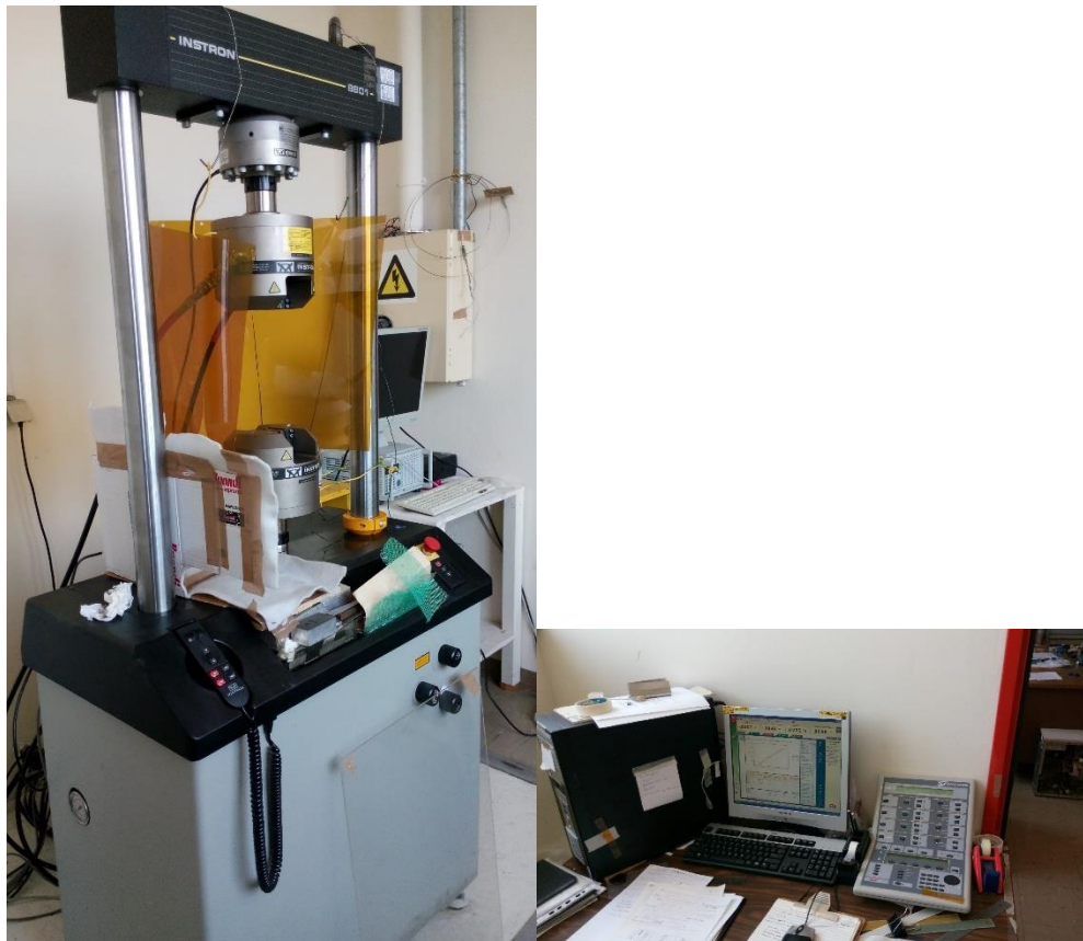
Εικόνα 4-13: Μηχάνη εφελκυσμού INSTRON και το σύστημα ελέγχου και καταγραφής των αποτελεσμάτων των δοκιμών μονοαξονικού εφελκυσμού
