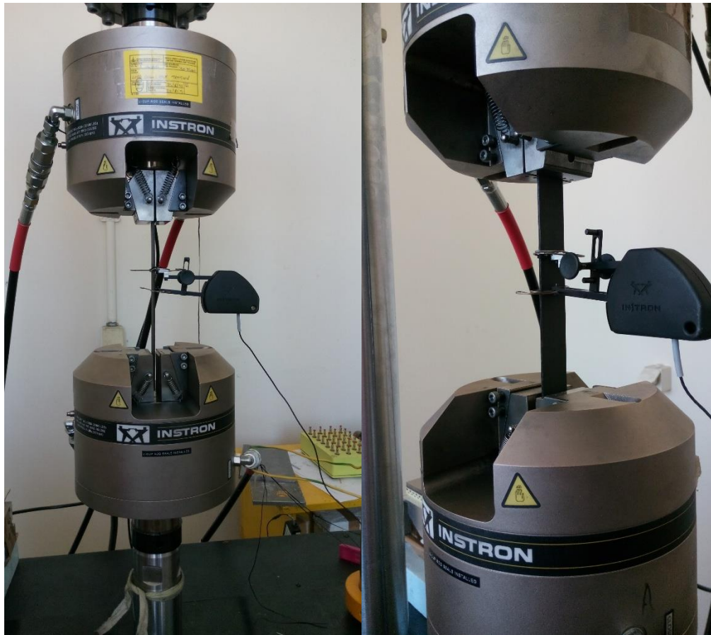
Εικόνα 4-14: Τοποθέτηση των σύνθετων υλικών στη μηχανή εφελκυσμού INSTRON
