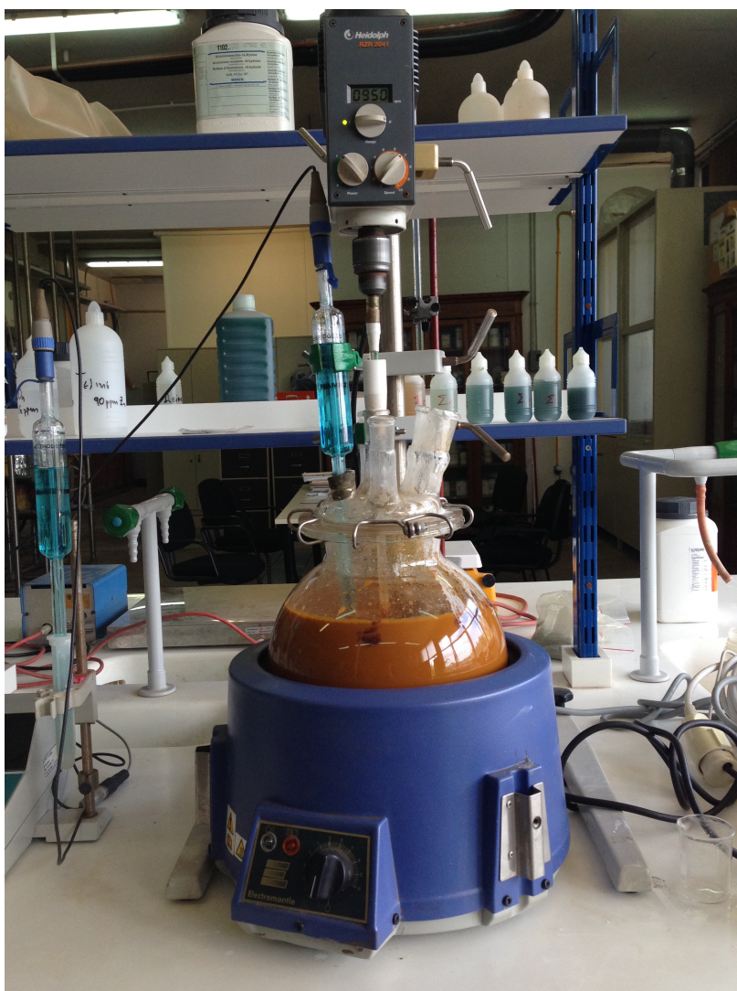
Εικόνα 6.1: Πειραματική διάταξη καταβύθισης σιδήρου από το διάλυμα εκχύλισης
