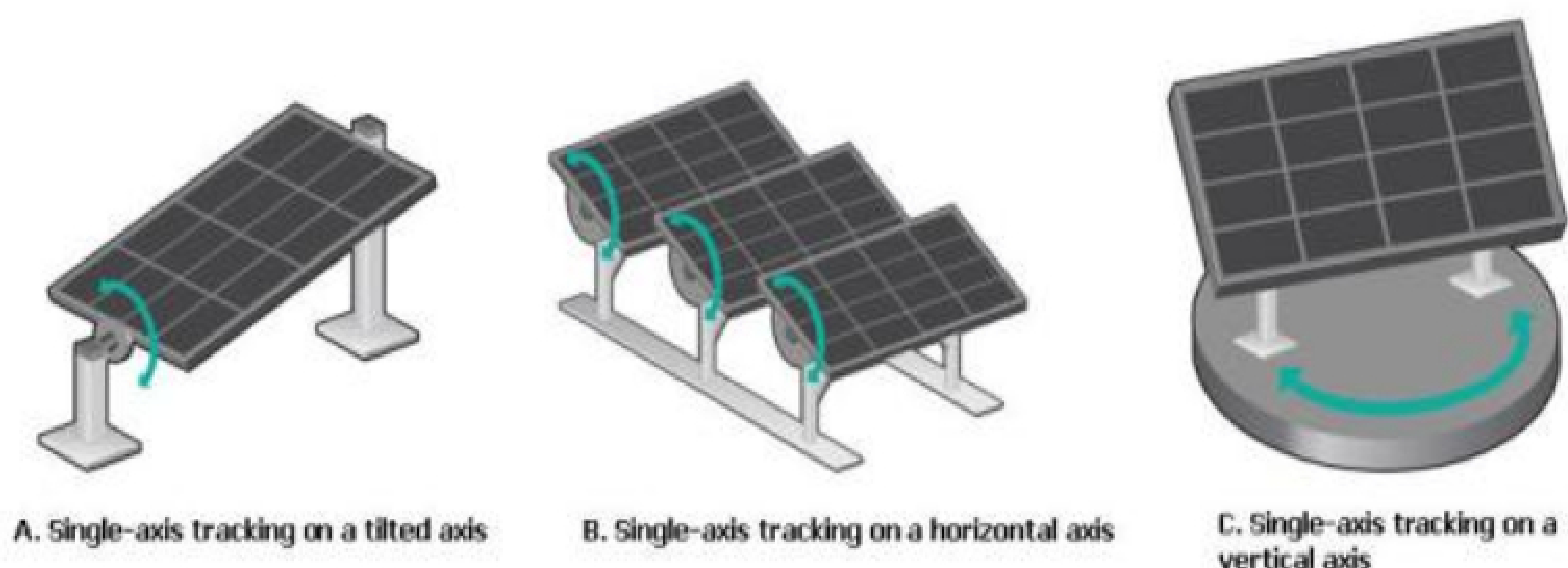
Σχ. 3.6 : Τρία συστήματα παρακολούθησης με έναν άξονα περιστροφής.
