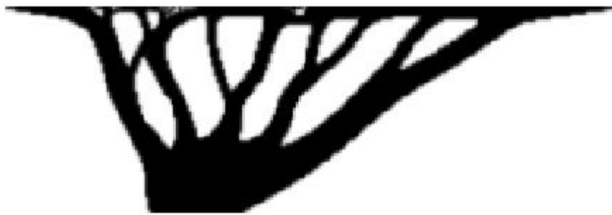
Εικόνα 41. Η δένδροειδής μορφή επιτυγχάνεται με κύκλους οι οποίοι αναγκάζουν την κατασκευή να αναπτύξει κλαδιά για να παραλάβει τις δυνάμεις.
