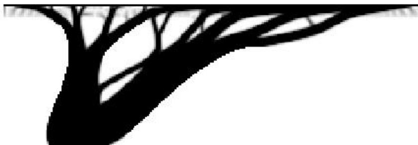
Εικόνα 33. Στατικές φορτίσεις ασκούμενες στο πάνω μέρος και θερμικές ασκούμενες επιφανειακά σε ένα κομμάτι του άνω μέρους της επιφάνειας
