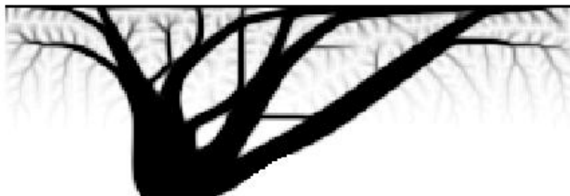
Εικόνα 32. Στατική φόρτιση στο πάνω μέρος της κατασκευής και θερμική φόρτιση κατανεμημένη επιφανειακά στο φθίνουσα κατά ύψος
