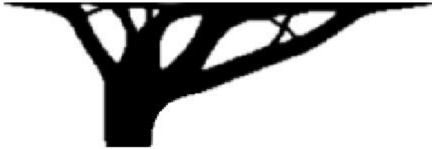
Εικόνα 40. Ο πίνακας avoid εμποδίζει την τοποθέτηση υλικού στο κάτω μέρος κοντά στη στήριξη της κατασκευής.
