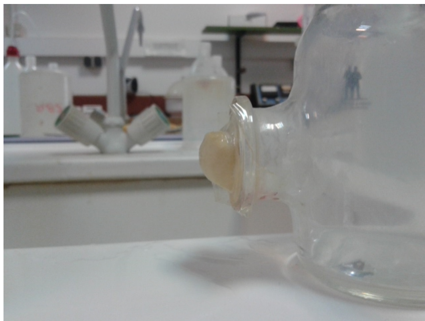
Σχήμα 118: Η παραμόρφωση της μεμβράνης προς την πλευρά της καθόδου κατά τον τρίτο κύκλο με τυρόγαλα
