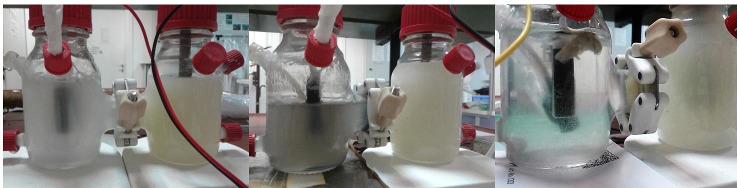
Σχήμα 115: Το σταδιακό θόλωμα του νερού του καθοδικού θαλάμου, το μετέπειτα μαύρισμα λόγω της διαρροής οργανικής ύλης και της απονέκρωσης της και το συσσωμάτωμα οργανικής ύλης στην επιφάνεια του καθοδικού θαλάμου
