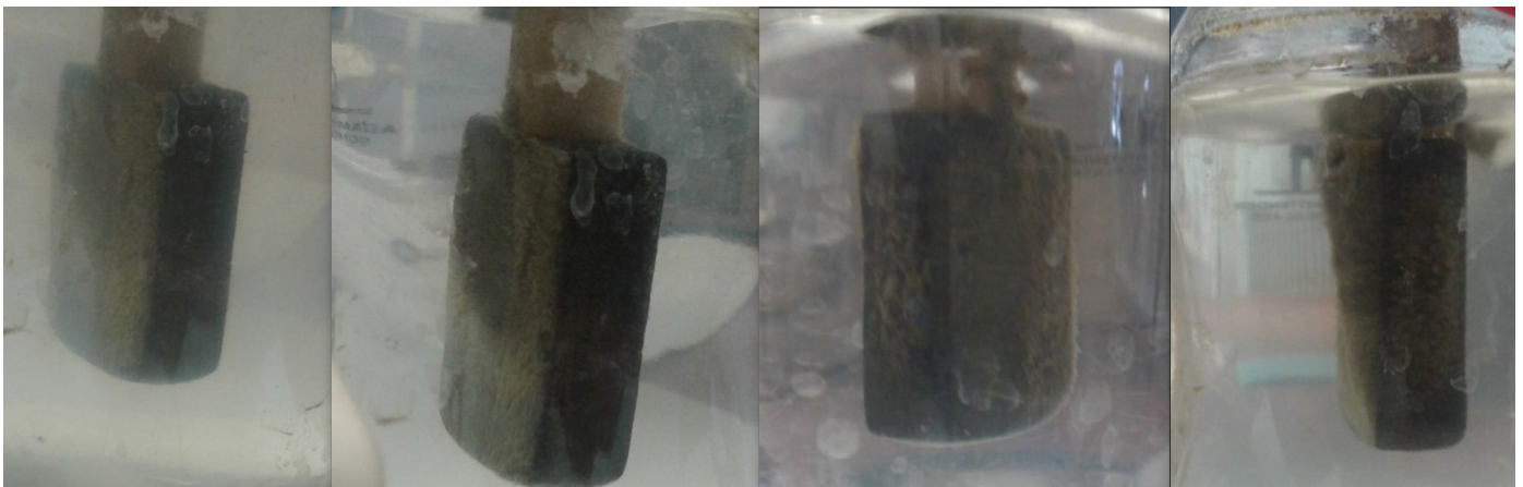
Σχήμα 39: Όψεις του ηλεκτροδίου της ανόδου κατά τη διάρκεια λειτουργίας της ΜΚΚ. Φαίνεται το όλο και πιο πυκνό στρώμα μικροοργανισμών που δημιουργείται. Οι εικόνες πάρθηκαν την 10η, 20ή, 26η και 30ή μέρα της διαδικασίας ανάπτυξης.
