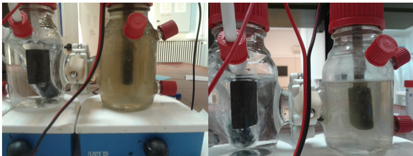
Σχήμα 76: Εικόνα του ανοδικού υγρού στην αρχή και στο τέλος του Έκτου κύκλου με πρωτοβάθμια επεξεργασμένα λύματα.
