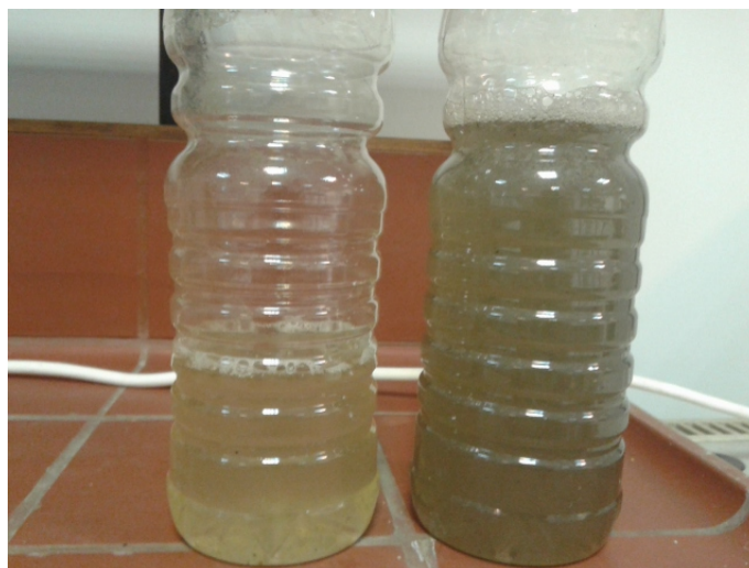
Σχήμα 97: Εικόνα του ανοδικού υγρού στην αρχή και στο τέλος του Τέταρτου κύκλου με ανεπεξέργαστα λύματα.
