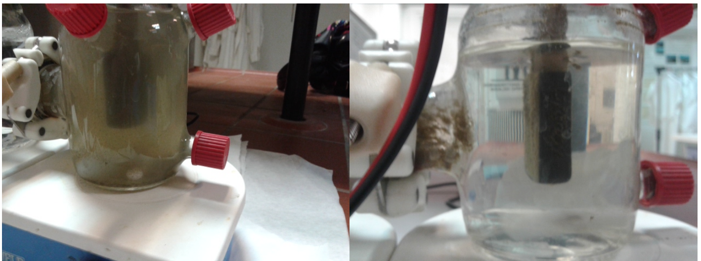
Σχήμα 91: Εικόνα του ανοδικού υγρού στην αρχή και στο τέλος του Τρίτου κύκλου με ανεπεξέργαστα λύματα.
