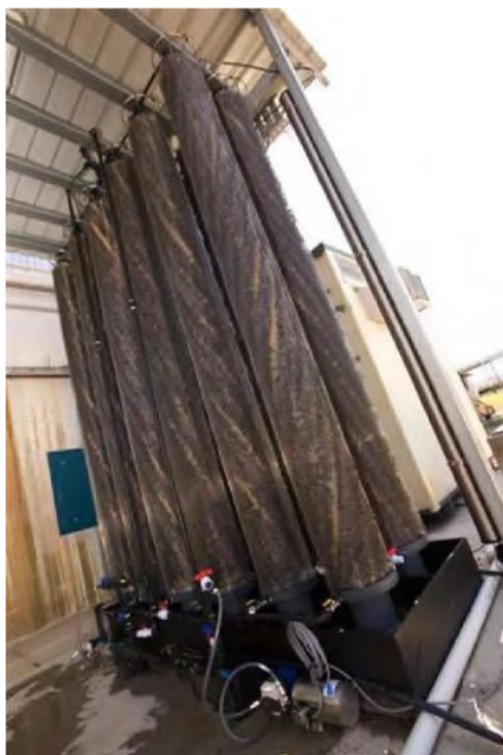
Σχήμα 25: Κυλινδρικές MKK σε μεγαλύτερη κλίμακα για την παραγωγή ισχύος χρησιμοποιώντας λύματα από τη μονάδα ζυθοποιίας Foster στην Yatala της Αυστραλίας
