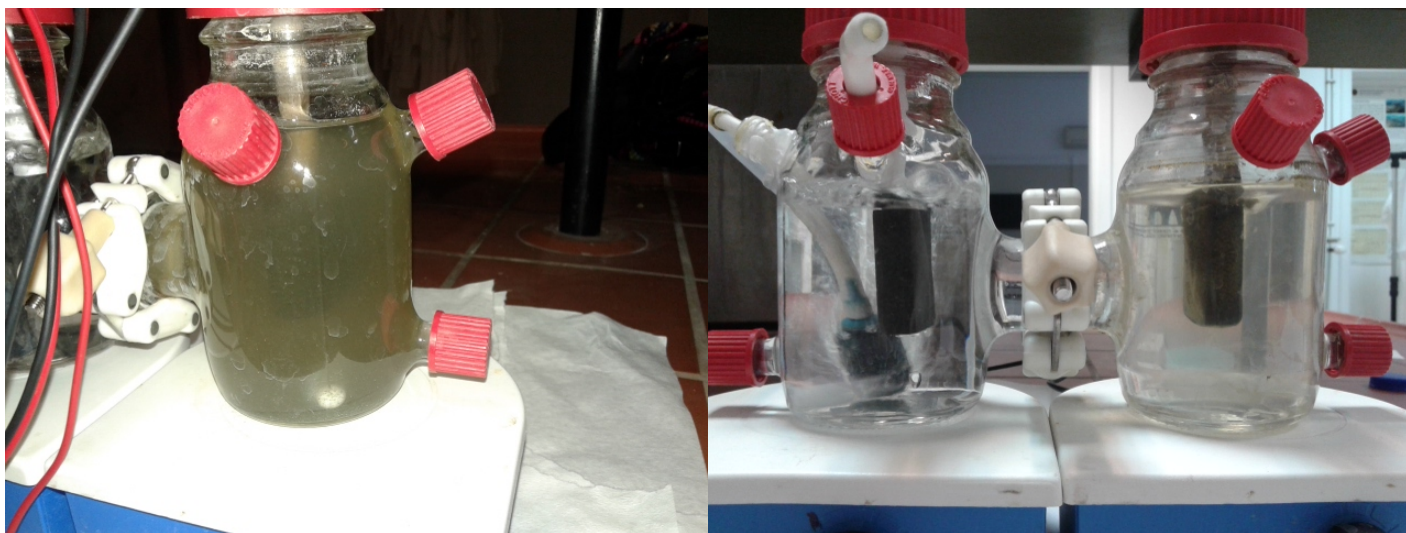
Σχήμα 79: Εικόνα του ανοδικού υγρού στην αρχή και στο τέλος του Πρώτου κύκλου με ανεπεξέργαστα λύματα.
