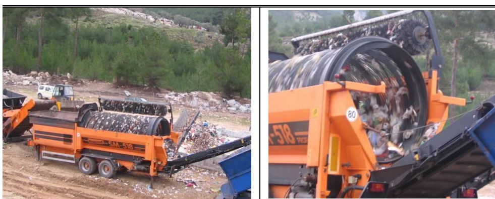
Εικόνα: Μονάδα Διαχωρισμού (Θάσος- ΔΙ.Α.Α.ΜΑ.Θ.- Δι.-Φο.Δι.Σ.Α.) [112]
