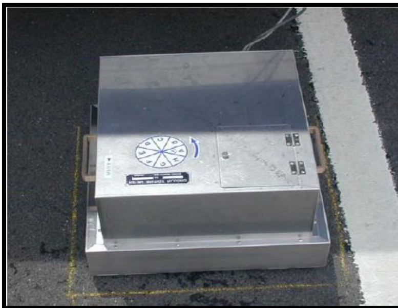
Εικόνα 3.15.: Μέθοδος καταγραφής της κυκλικής κατατομής (Hanson & Prowell, 2004)
