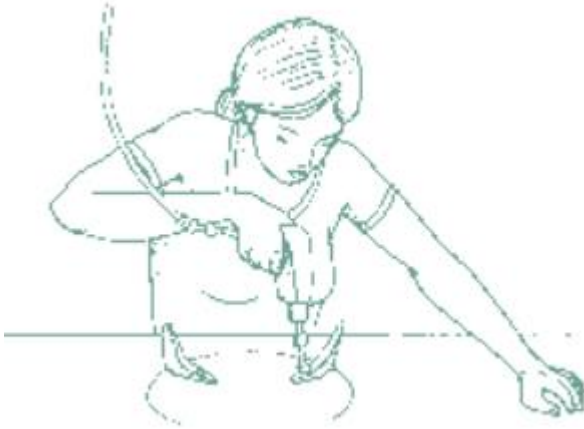
Εικόνα 4.4 Το σχήμα του εργαλείου οδηγεί στην ωλένια απόκλιση του καρπού του εργαζομένου (Serge, St-Vincent, & Chicoine, 1996)
