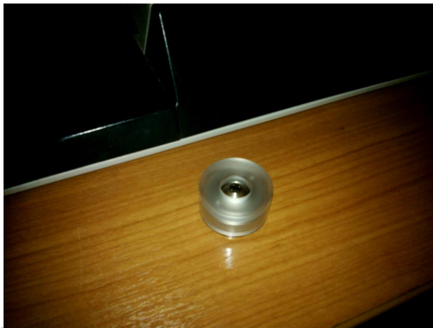
Εικόνα 4.4.1 Φωτογραφία του μαγνητοοπτικού αισθητήρα που προσαρμόζεται σαν κεφαλή στο οπτικό μικροσκόπιο Leica DM RXP.
