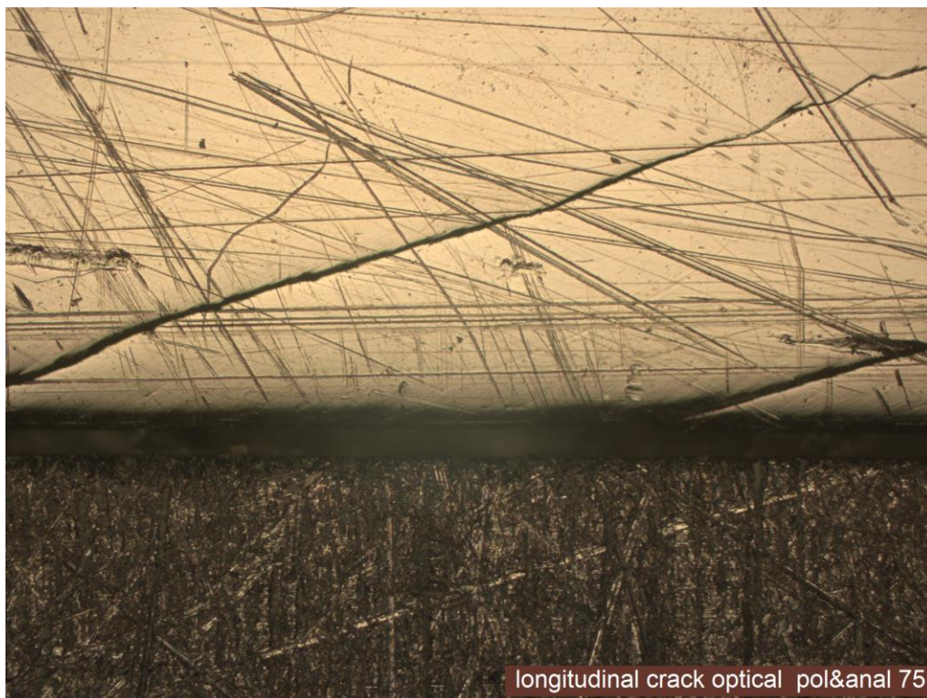
Εικόνα 4.7.2: Λεπτομέρειες δύο ρωγμών της διαμήκουσ στιλβωμένης επιφάνειας του σχήματος 4.7.3. Η απόσταση των ρωγμών στην επιφάνεια της σιδηροτροχιάς είναι περίπου 3 mm.
