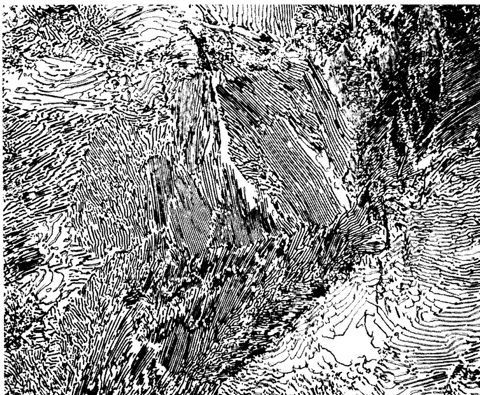
Εικόνα 2.1.1 Περλίτης σε χάλυβα Fe-0.75C. Οπτικό μικροσκόπιο 500X. (5)
