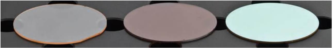
Εικόνα 4.2.1: Ο μαγνητοοπτικός αισθητήρας στα διάφορα στάδια κατασκευής του: (από αριστερά στα δεξιά) αρχικό προστατευτικό υπόστρωμα, επικάλυψη με επίστρωση μαγνητοοπτικού υλικού, επικάλυψη με ανακλαστική επιφάνεια.
