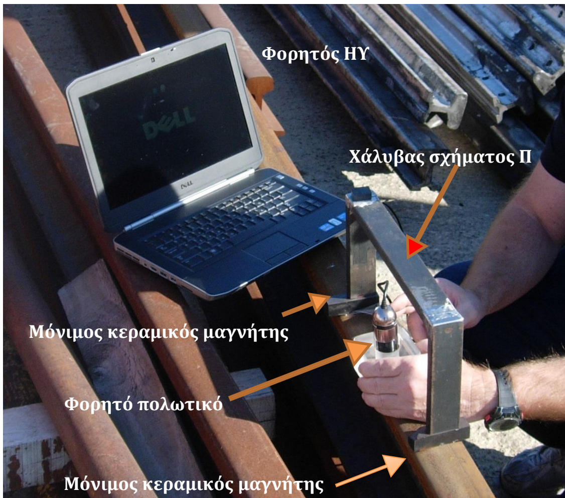
Εικόνα 4.4.5 Διάταξη εντοπισμού ρωγμών RCF σε σιδηροτροχιές της ΣΤΑΣΥ ΑΕ.
