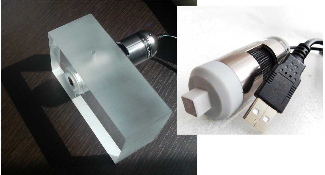
Εικόνα 4.4.3 Φορητό μικροσκόπιο με ενσωματωμένο μαγνητοοπτικό αισθητήρα. Αριστερά, φωτογραφία με το μικροσκόπιο μαζί με την βάση που κατασκευάστηκε. Δεξιά, κοντινή φωτογραφία του φορητού μικροσκοπίου.
