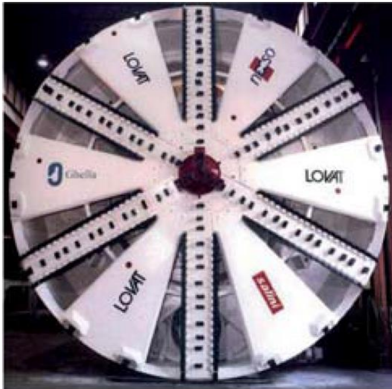
Εικόνα 55: EPB TBM (Guglielmetti V., 2008)
