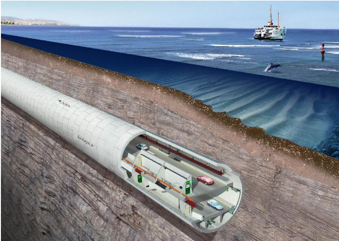
Εικόνα 18: Σχηματική απεικόνιση υποπυθμίνιας σήραγγας (unibasin.instabul.edu.tr)
