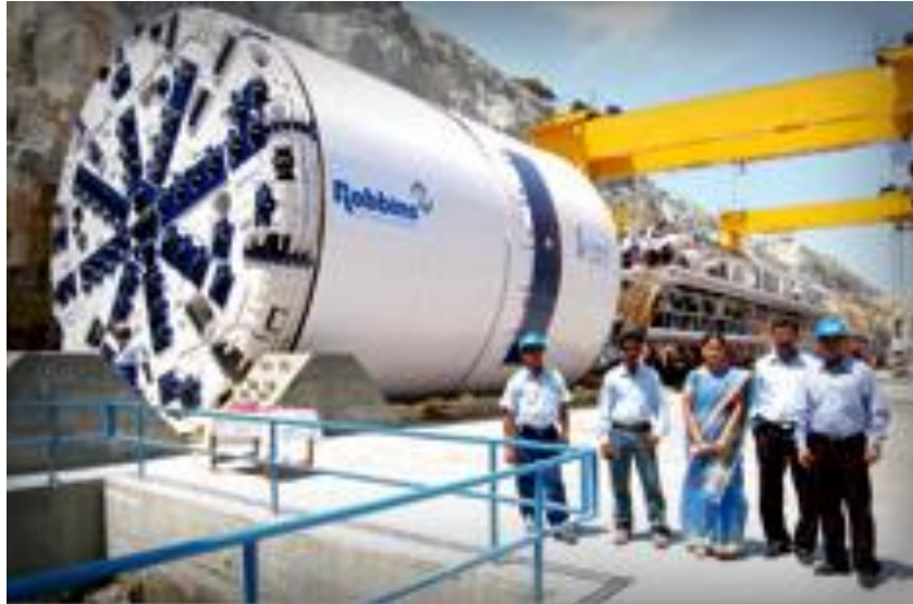
Εικόνα 53: Double Shield TBM (therobbinscompany.com)
