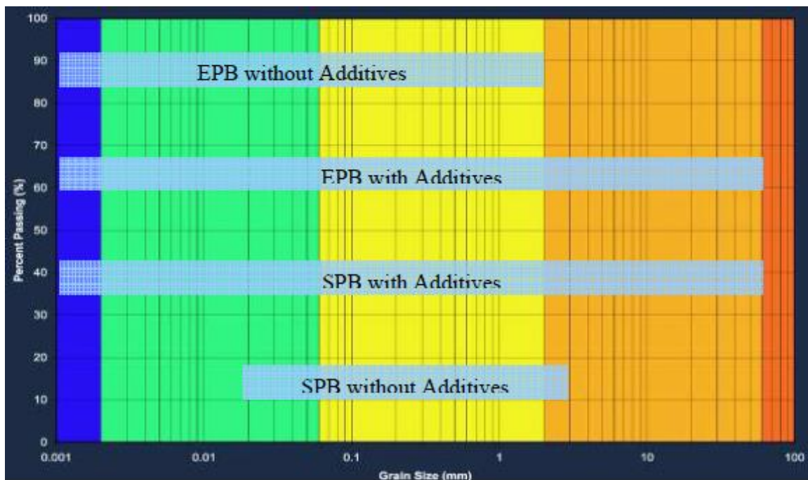
Εικόνα 65: Πεδίο εφαρμογής EPB & SPB TBM (Lovat R., 2007)
