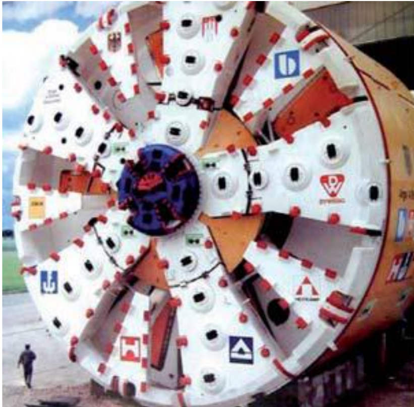
Εικόνα 56: Slurry Shield TBM (Guiglielmetti V., 2008)
