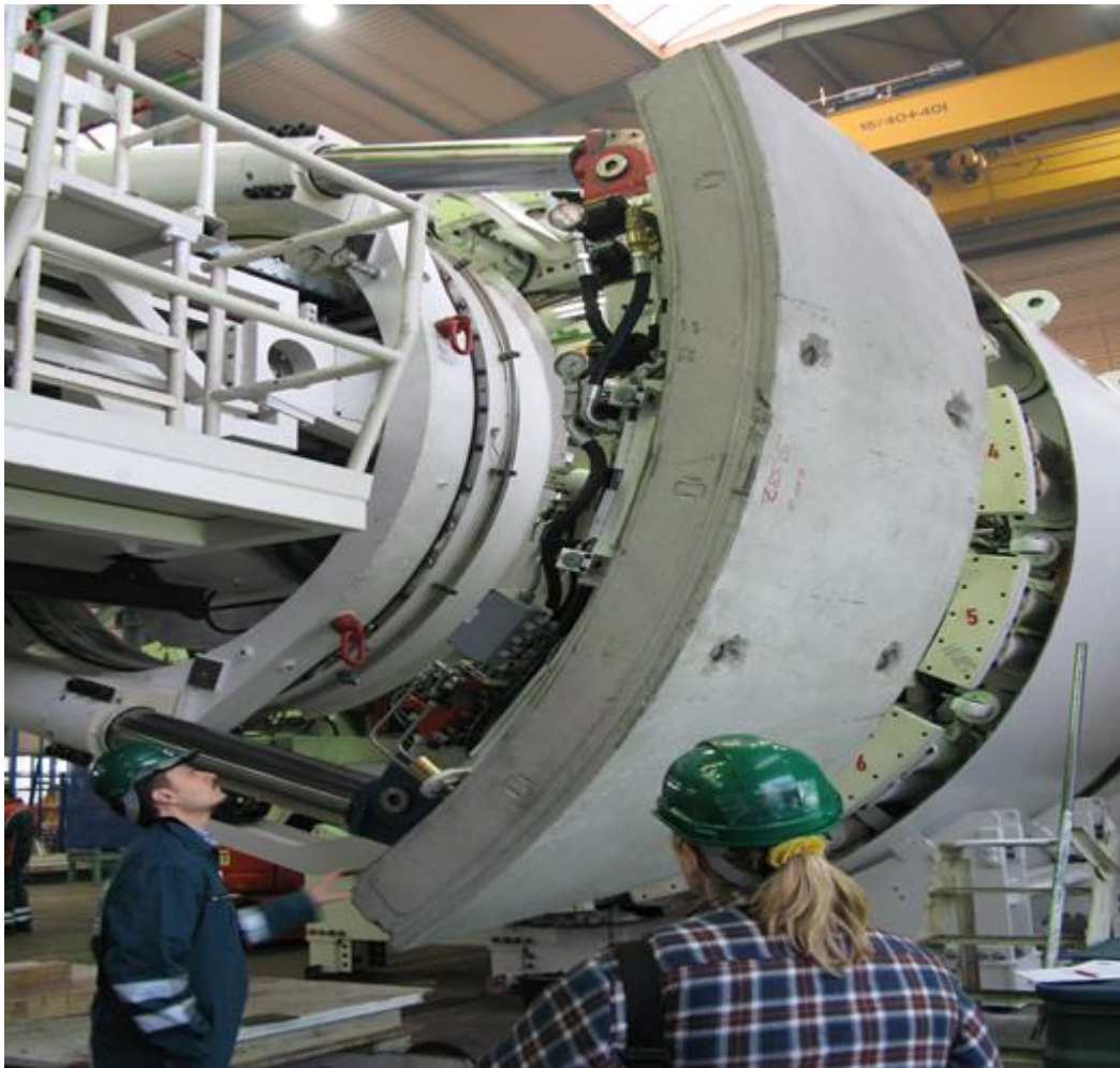
Εικόνα 75: Segments EPB TBM, Εργοστασιακή δοκιμή στο εργοστάσιο της Herrenknecht (Μετρό Θεσσαλονίκης Φ6,2m)
