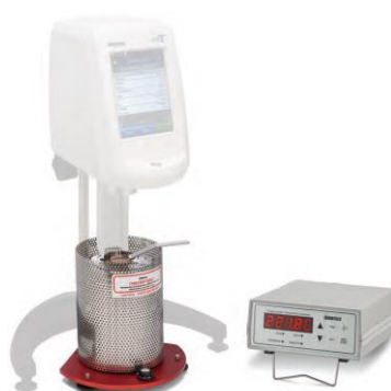
Εικόνα 4.2: Συσκευή μέτρηση ιξώδους Brookfield Viscometers and DV3T Rheometers
