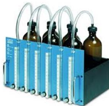
Εικόνα 4.1: Συσκευή μέτρηση BOD VELP BOD
