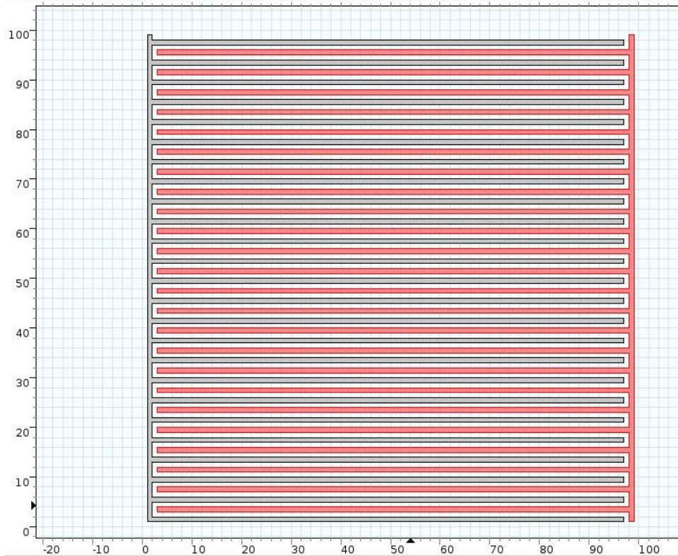
Εικόνα 4.8: Διαχωρισμός των συστοιχιών ηλεκτροδίων σε πύλης και γης.
