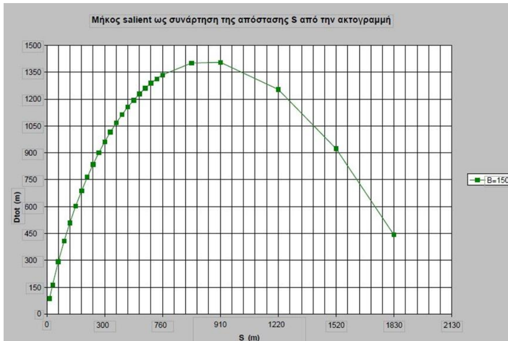
Εικόνα 5-9: Αποτύπωση της επίδρασης την απόστασης S από την ακτογραμμή στο μήκος του salient Dtot.
