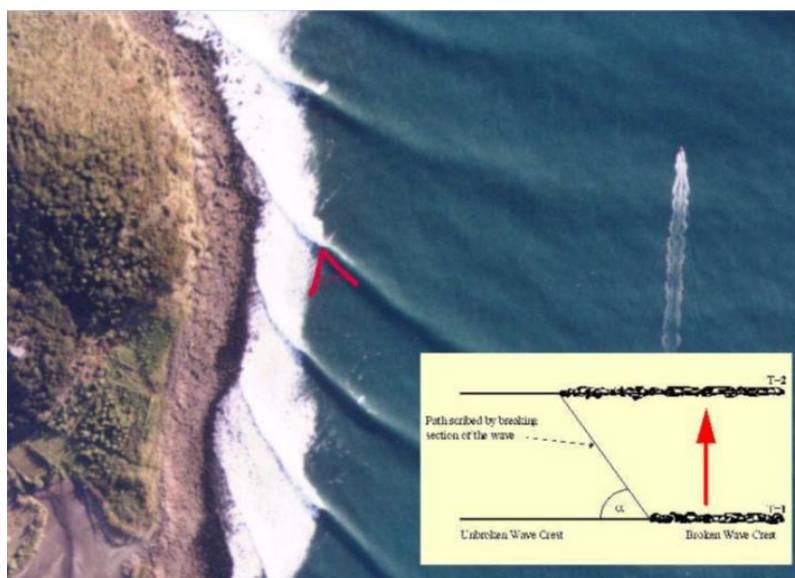
Εικόνα 4-4: Απεικόνιση γωνίας θραύσης κυματισμού (Mead,2001).
