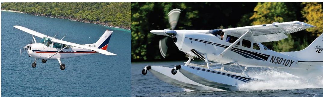
Εικόνα 17: Αεροσκάφος τύπου Cessna με τυπικό σύστημα προσγείωσης και με πλωτήρες
