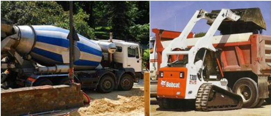
Εικόνα 4.2: α) Όχημα μεταφοράς νωπού σκυροδέματος, β) Φορτωτάκι BobCat κατά την απόθεση των υλικών της εκσκαγής σε φορτηγό όχημα.
