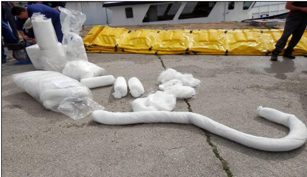
Εικόνα 3. 10: Απορροφητικά υλικά απορρύπανσης, σε περίπτωση πετρελαιοκηλίδας. (Πηγή: http://www.alexpolisonline.com/2014/06/blog-post_6.html )
