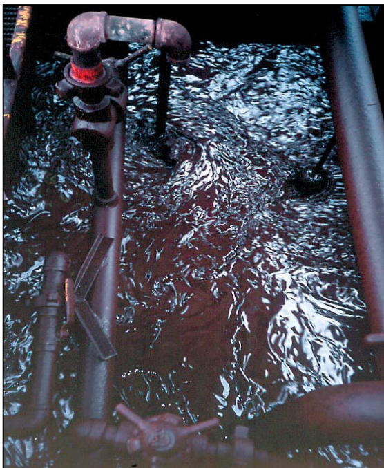
Εικόνα 3.3: Ανάδευση των ρευστών διάτρησης. (Πηγή: OGP Report Number 396, 2009)
