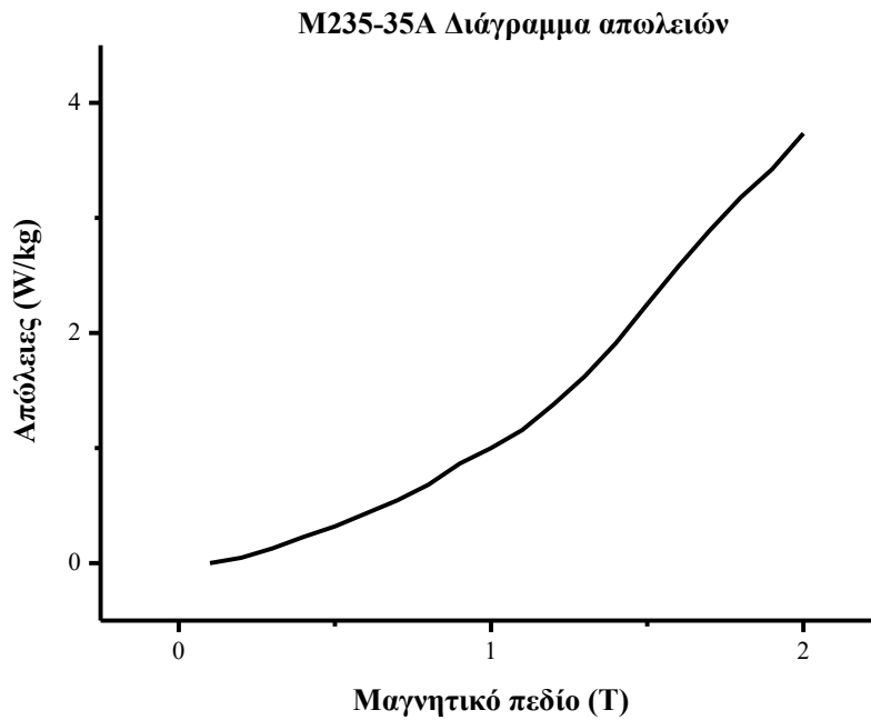
Σχήμα 7.8: Καμπύλη ειδικών απωλειών σιδηρομαγνητικής λαμαρίνας M235-35 A
