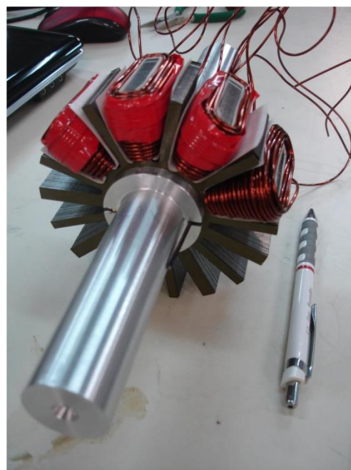
Σχήμα 7.3: Εικόνες από το στάτη του κινητήρα. Φαίνεται η διαμόρφωση των τυλιγμάτων πάνω στις αύλακες του στάτη.
