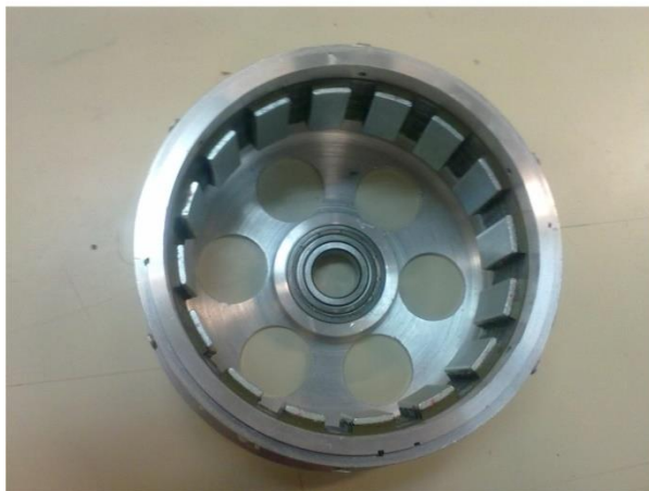
Σχήμα 7.2: Εικόνες από την κατασκευή του κινητήρα του «Πυρφόρου II» Αριστερά: φαίνονται οι μαγνήτες στον δρομέα της μηχανής. Δεξιά: Κλειστό το κέλυφος του κινητήρα του «Πυρφόρου II»
