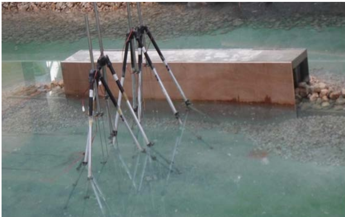
Εικόνα 4.1. Απορροφητικός κρηπιδότοιχος με κατακόρυφο μέτωπο
