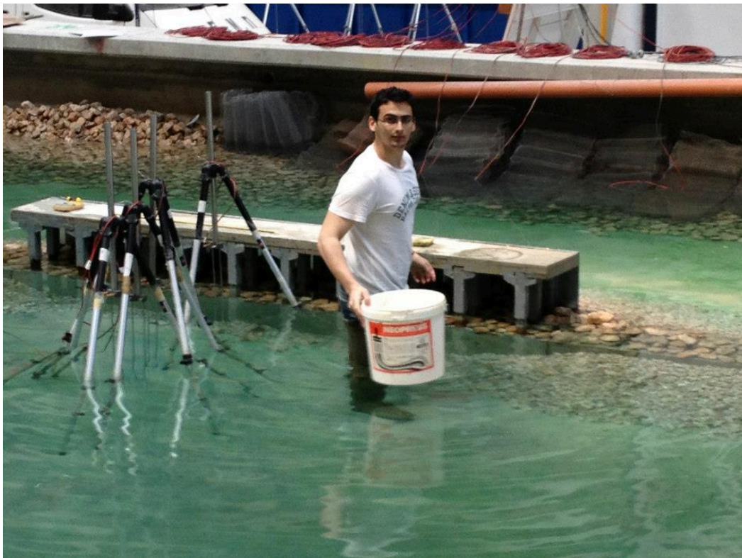
Εικόνα 4.3. Αλλαγή κλίσεως πρανών για τη διάταξη \Delta 4
