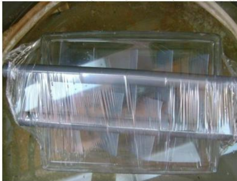
ΕΙΚΟΝΑ 8: Διάταξη δοκιμίων στον θάλαμο εμβάπτισης
