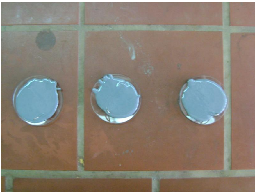
ΕΙΚΟΝΑ 11: Διάταξη υάλων με το προστατευτικό επίστρωμα σε υγρή μορφή
