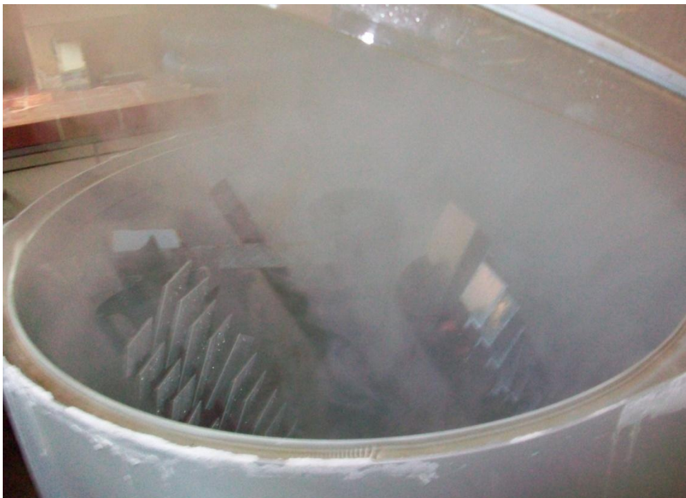
ΕΙΚΟΝΑ 5: Διάταξη Δοκιμίων μέσα στο Θάλαμο Αλατοnéφωσης
