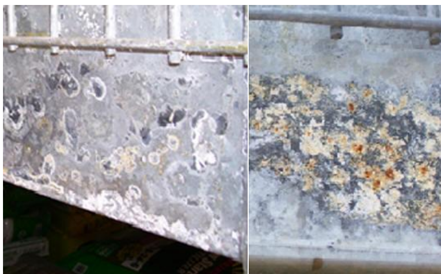
2.2.4 Γαλβανική ή διμεταλλική διάβρωση αρχικό και προχωρημένο στάδιο
