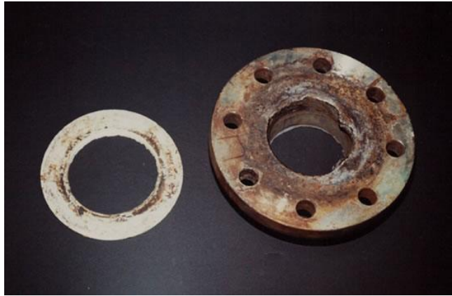
2.2.3 Διάβρωση χαραγής (crevice corrosion)
