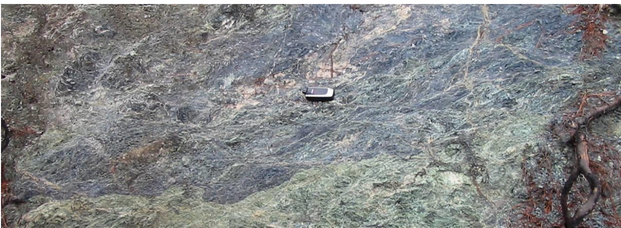
Φωτογραφία 15.2. Σερπεντινίτης από την περιοχή του φράγματος στην πιο βραχώδη του μορφή.
