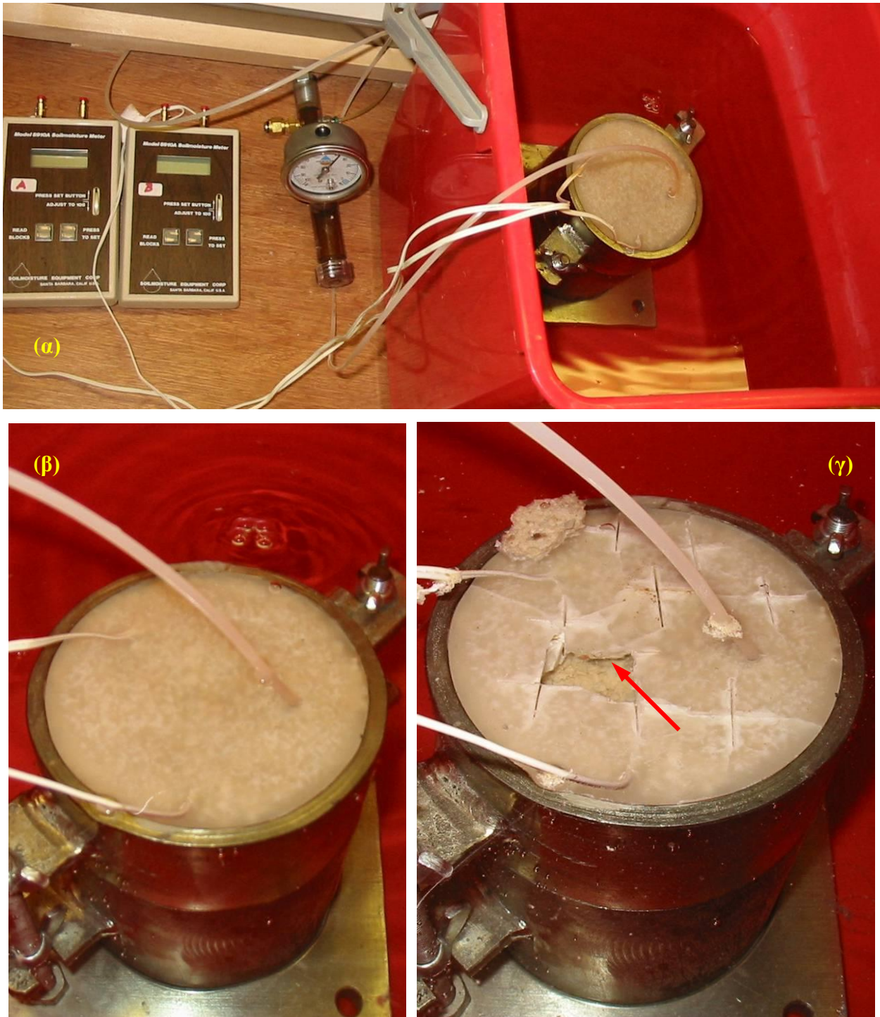
Φωτογραφία 3.7. α) Διάταξη μέτρησης της μύζησης με εργαστηριακό тенσιόμετρο και τεμάχια γύψου (διακρίνονται οι μετρητές/καταγραφικά και το μανόμετρο μέτρησης του тенσιόμετρου) του εργαστηρίου της ΕΔΑΦΟΣ Α.Ε. κατασκευής Soil Moisture Inc. σε συμπυκνωμένη χονδρόκοκκη άμμο εντός μήτρας Proctor 4'' κατά την τοποθέτησή της σε δοχείο με νερό, β) επιφάνεια μήτρας με την παραφίνη από όπου φαίνονται να διαφεύγουν φυσαλίδες αέρα από μικρή αδιόρατη οπή, και γ) επιφάνεια της μήτρας μετά την διάτρηση της παραφίνης και της αποκόλλησης και ενός τμήματός της (διακρίνεται από κάτω το κενό λόγω συρρίκνωσης της άμμου κατά την διαβροχή –επισημαίνεται με βέλος).
