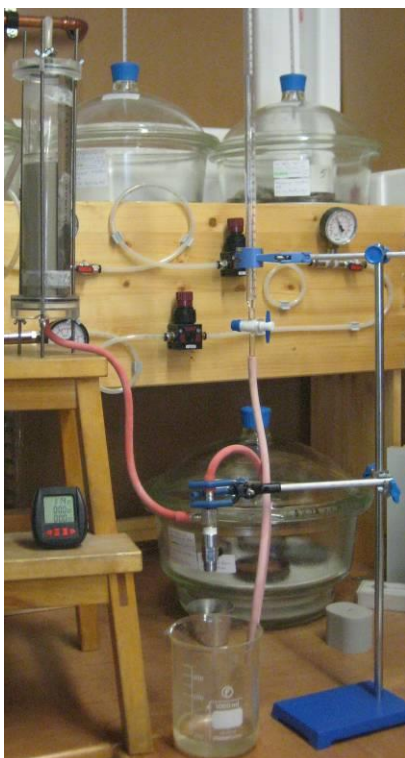
Φωτογραφία 14.13. α) Διάταξη τροποποιημένου κελιού Tempre με το δοκίμιο της αναζυμωμένης μάργας Κορίνθου, και β) λεπτομέρεια συρρίκνωσης του πολτού στην επιφάνεια του οποίου υπάρχει νερό (διακρίνεται το σημείο από το οποίο άρχισε η συρρίκνωση).
