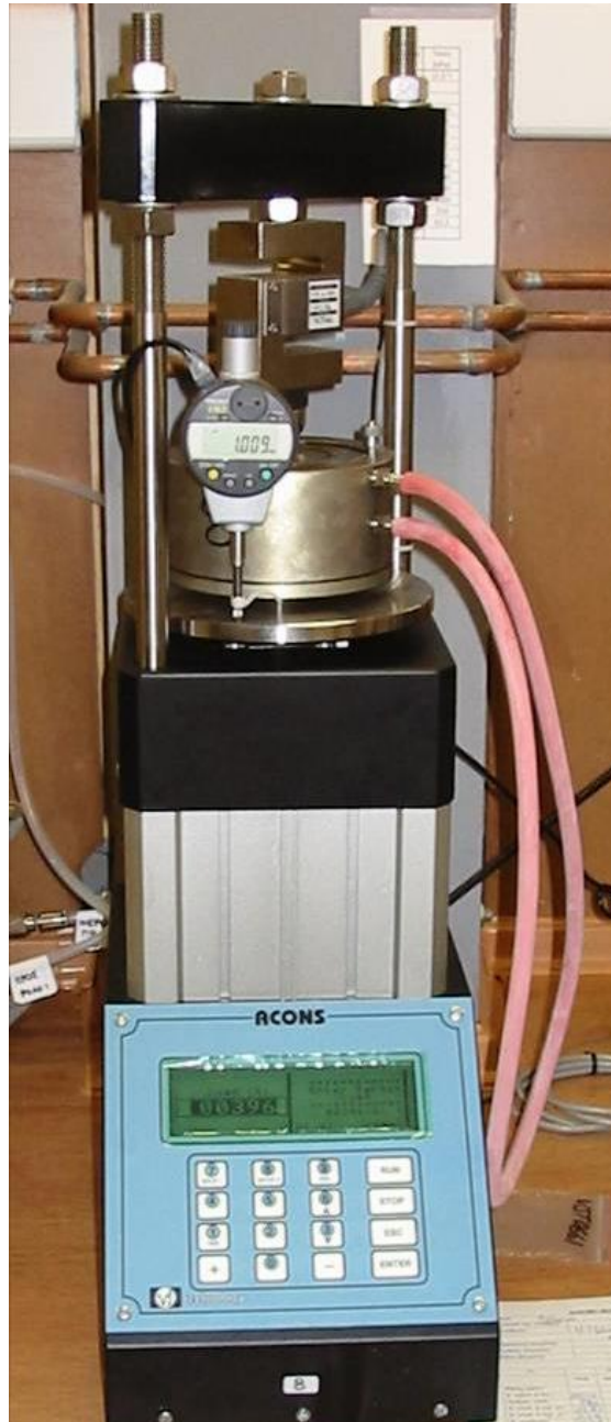
Φωτογραφία 15.8. Αυτόματο πνευματικά ελεγχόμενης πίεσης συμπιεσόμετρο μέγιστης εφαρμοζόμενης δύναμης 15 kN κατασκευής VJTech του εργαστηρίου της ΕΔΑΦΟΣ Α.Ε.
