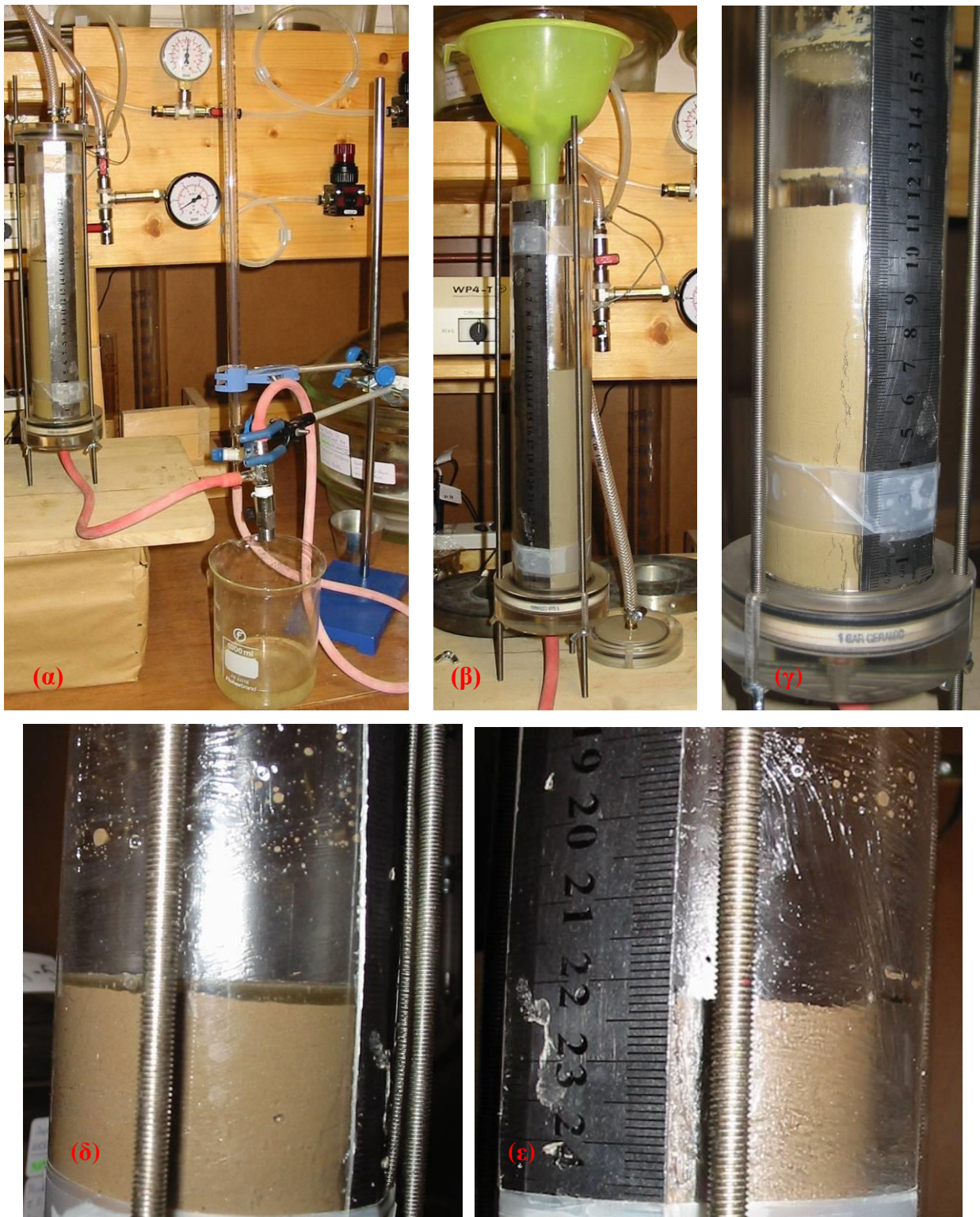
Φωτογραφία 14.11. α) Διάταξη τροποποιημένου κελιού Tempre, β) χωρίς το καπάκι και τοποθετημένο το χωνί για την εισαγωγή πολτού, γ) λεπτομέρεια δοκιμίου στο οποίο εμφανίστηκε διαμπερές διαμήκης ρωγή λόγω ελλιπούς λίπανσης της εσωτερικής παρειάς, δ) λεπτομέρεια συρρίκνωσης πολτού στην επιφάνεια του οποίου υπάρχει νερό (διακρίνεται το σημείο από το οποίο άρχισε η συρρίκνωση), και ε) το ίδιο δοκίμιο μετά από αποκόλληση του δοκιμίου από την εσωτερική παρειά του σωλήνα.
