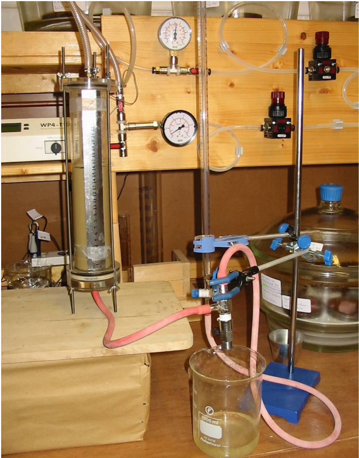
Φωτογραφία 4.1. Τροποποιημένο κελί Tempre που αναπτύχθηκε στα πλαίσια της παρούσας διδακτορικής διατριβής (βλ. Κεφ. 14). Διακρίνεται η μπιρέτα στην οποία συλλέγεται το νερό που εξέρχεται από το δοκίμιο και η βαλβίδα εκκένωσης της πάνω από το ποτήρι ζέσεως.
