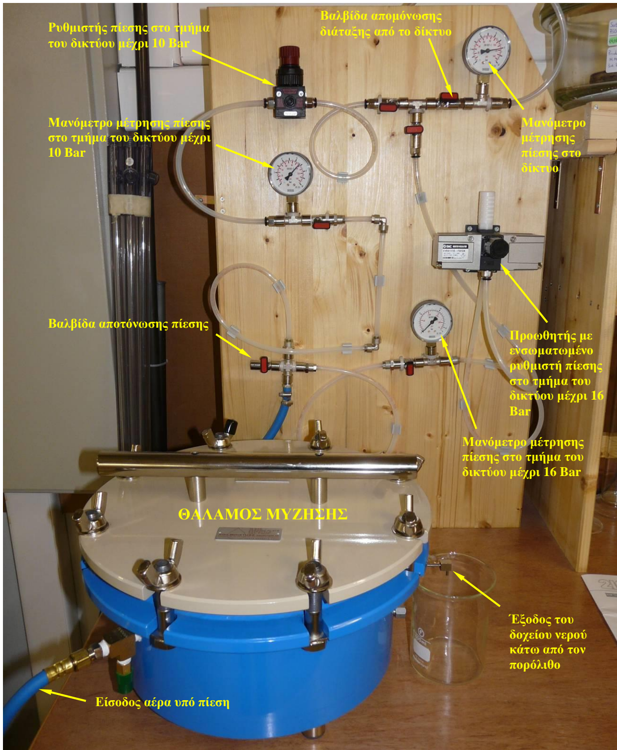
Φωτογραφία 14.4. Διάταξη ρύθμισης πίεσης αέρα στον θάλαμο μύζησης του Εργαστηρίου της ΕΛΑΦΟΣ Α.Ε. με ρυθμιστή πίεσης, προωθητή, μανόμετρα για την μέτρηση της πίεσης και βαλβίδες απομόνωσης τμημάτων της διάταξης. Κάτω διακρίνεται ο θάλαμος μύζησης με την είσοδο του αέρα υπό πίεση και την έξοδο του δοχείου νερού κάτω από τον πορόλιθο με ποτήρι ζέσεως για την συλλογή του νερού.
