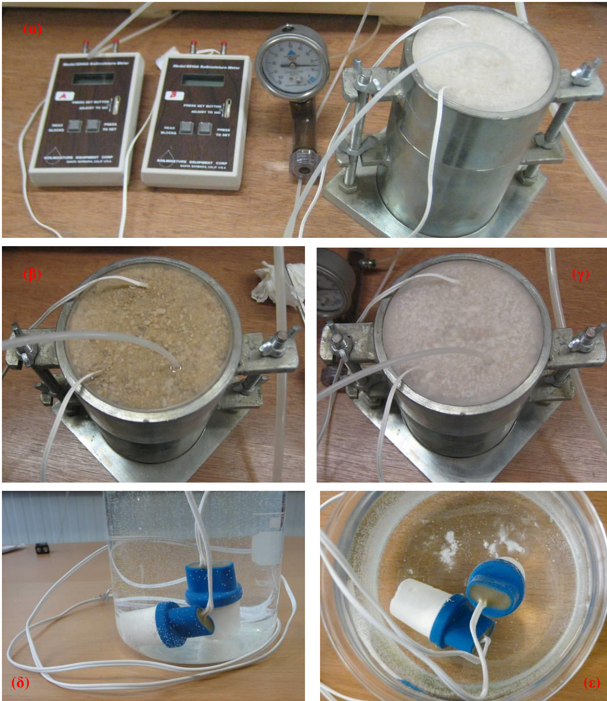
Φωτογραφία 3.6. α) Διάταξη μέτρησης της μύζησης με εργαστηριακό тенσιόμετρο και τεμάχια γύψου (διακρίνονται οι μετρητές/καταγραφικά και το μανόμετρο μέτρησης του тенσιομέτρου) του εργαστηρίου της ΕΔΑΦΟΣ Α.Ε. κατασκευής Soil Moisture Inc. σε συμπυκνωμένη χονδρόκοκκη άμμο εντός μήτρας Proctor 4'', β) επιφάνεια μήτρας με την παραφίνη υγρή αμέσως μόλις χύθηκε, και γ) μετά την πήξη της, δ) και ε) τα δύο τεμάχια γύψου που χρησιμοποιήθηκαν κατά την εμβάπτισή τους σε νερό για επίτευξη πλήρους κορεσμού τους πριν την χρησιμοποίησή τους (διακρίνονται ίχνη γύψου που έχει διαλυθεί και κάθεται σαν ίζημα στον πυθμένα του δοχείου).
