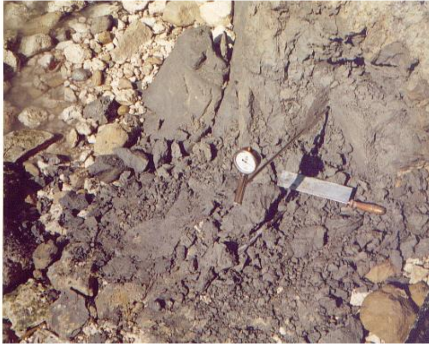
Φωτογραφία 3.14. Επιτόπου μέτρηση της μύζησης με тенσιόμετρο τύπου Quickdraw του Εργαστηρίου Θεμελιώσεων του Τομέα Γεωτεχνικής (κατασκευής Soilmoisture Equipment Corp.) στη θέση απόληξης των δειγμάτων Μάργας Κορίνθου που χρησιμοποιήθηκαν στην εργαστηριακή διερεύνηση στα πλαίσια της παρούσας διδακτορικής διατριβής.
