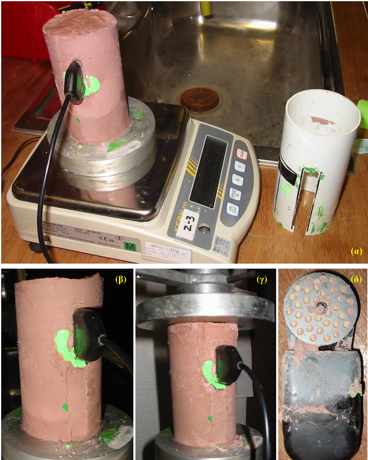
Φωτογραφία 15.13. α) Δείγμα αναζυμωμένου αποσαθρωμένου Φυλλίτη Σκύρου μετά την ξήρανσή του σε βαθμό τέτοιο που να μπορεί να αφαιρεθεί ο πλαστικός τύπος εντός του οποίου μορφώθηκε, ο οποίος διακρίνεται δεξιά με την οπή για την τοποθέτηση του MPS-2, β) το δοκίμιο με καλύτερη άποψη του άκρου του MPS-2 όπως εξέρχεται από αυτό, γ) το δοκίμιο επί του πλαισίου φόρτισης κατά την θλίψη, και δ) ο αισθητήρας μετά την αφαίρεσή του από το δοκίμιο (διακρίνεται η καλή επαφή υλικού και πορώδους υλικού αισθητήρα).
