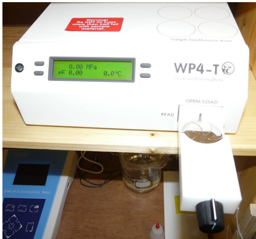
Φωτογραφία 14.8. Το υγρόμετρο ψυχρού κατόπτρου του εργαστηρίου της ΕΔΑΦΟΣ Α.Ε. κατασκευής Decagon Devices, Inc. Διακρίνεται με ανοικτό τον θάλαμο εισαγωγής δοκιμίου.
