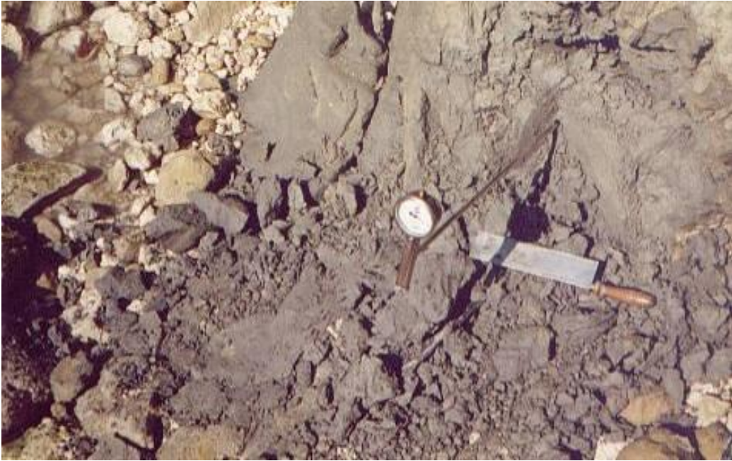
Φωτογραφία 14.12. Μέτρηση της μύξης επιτόπου στη θέση αποκοπής αδιατάρακτων δειγμάτων Μάργας Κορίνθου με το тенσιόμετρο Quickdraw Suction Probe της SoilMoisture Inc. Μετρήσεις με το ίδιο όργανο πραγματοποιήθηκαν και στα δείγματα της Μάργας Κορίνθου πριν την τοποθέτησή τους στο θάλαμο μύξης για τον προσδιορισμό της χαρακτηριστικής καμπύλης εδάφους-νερού.
