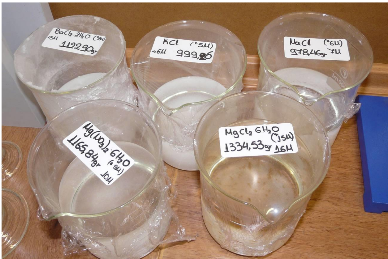
Φωτογραφία 14.5. Ποτήρια ζέσεως με τα κορεσμένα υδατικά διαλύματα μετά την ολοκλήρωση των δοκιμών επίτευξης κορεσμού των διαλυμάτων. Διακρίνονται οι καρτέλες με το περιεχόμενο του καθενός καθώς και το σχηματισμένο ίζημα στον πυθμένα τους.
