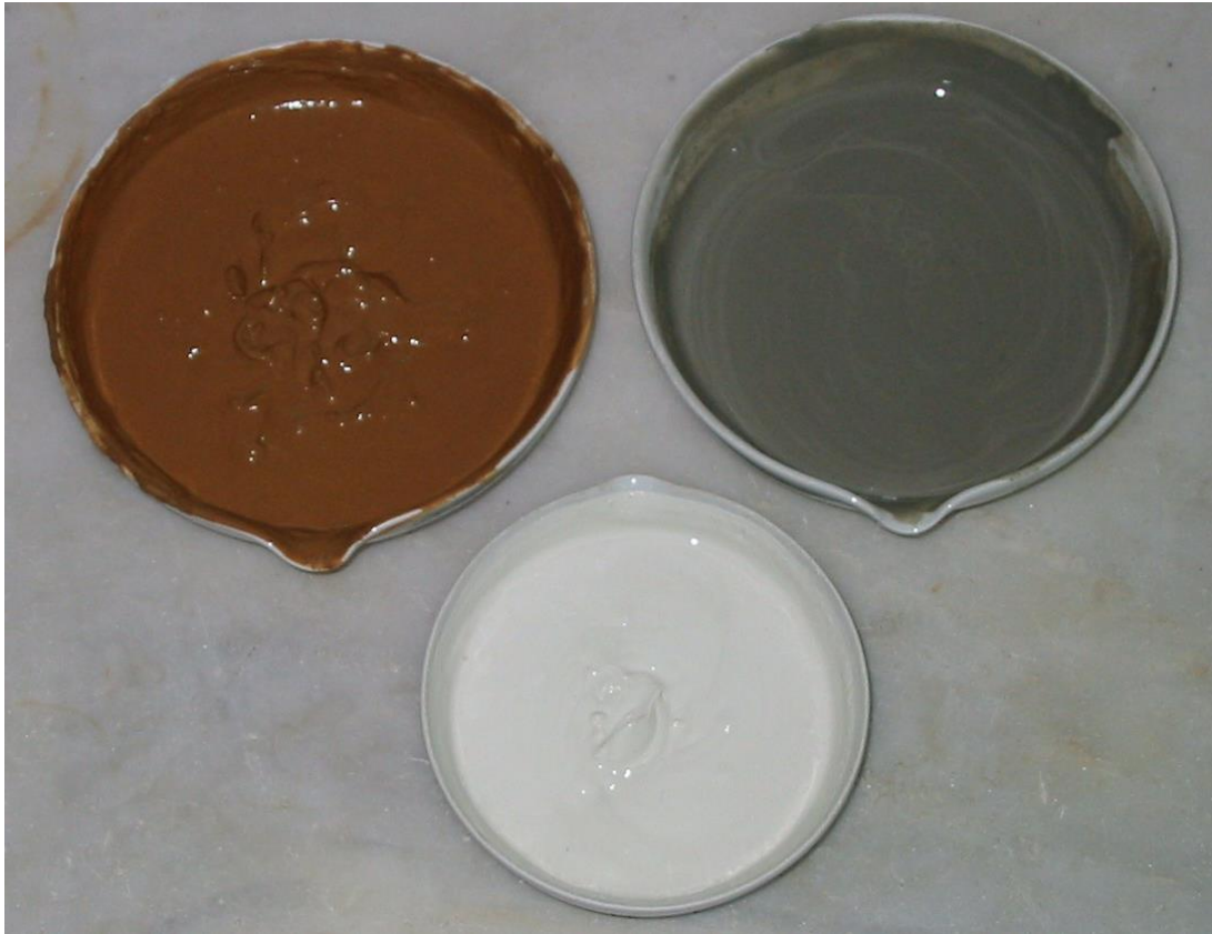
Φωτογραφία 10.1. Αναζυμωμένα αργιλικά εδάφη. Παρασκευάζονται μέσα σε δοχεία όπως οι κάψες της φωτογραφίας καθώς βρίσκονται σε ημίρευστη ως ρευστή κατάσταση. Πρόκειται για Άργιλο Χανίων (πάνω αριστερά), Μάργα Κορίνθου (πάνω δεξιά) και Καολίνη τύπου Speswhite (κάτω).
