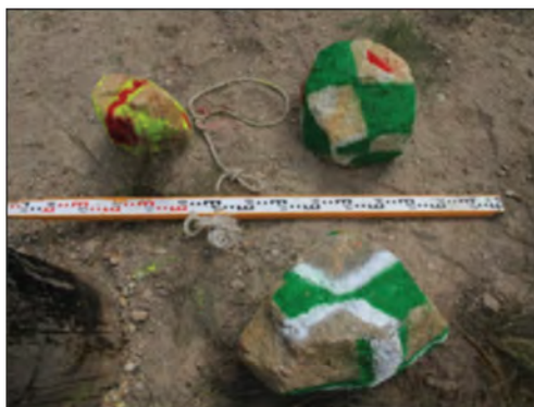
Σχήμα 3.37: Σήμανση τεμαχών για τον προσδιορισμό της γωνιακής ταχύτητας (Spadari et al., 2012)
