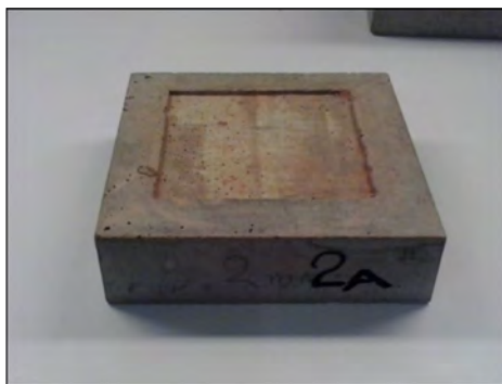
Σχήμα 4.13: Βάση πρόσκρουσης για δοκιμές με εδαφική επικάλυψη πάχους t = 2mm
