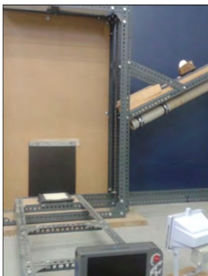
Σχήμα 4.16: Πειραματική διάταξη εκτέλεσης δοκιμών με δοκίμια ελλειπτικών δίσκων
