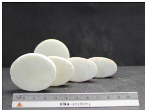
Σχήμα 4.9: Δοκίμια ελλειπτικών δίσκων με λόγους ημιαξόνων 1.25, 1.5, 1.75 και 2, από τα αριστερά προς τα δεξιά της εικόνας
