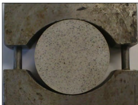
Σχήμα 4.21: Διάταξη της δοκιμής Brazil για τον έμμεσο προσδιορισμό της εφελκυστικής αντοχής
