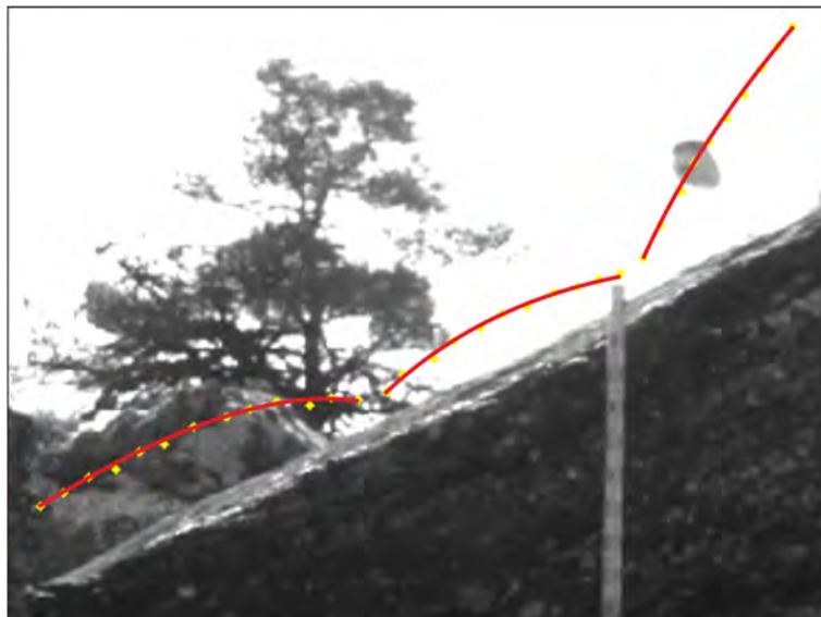
Σχήμα 7.6: Διαγραφόμενη τροχιά σε δοκιμή που συμβαίνουν δύο κρούσεις του τεμαχίου στο πρανές
