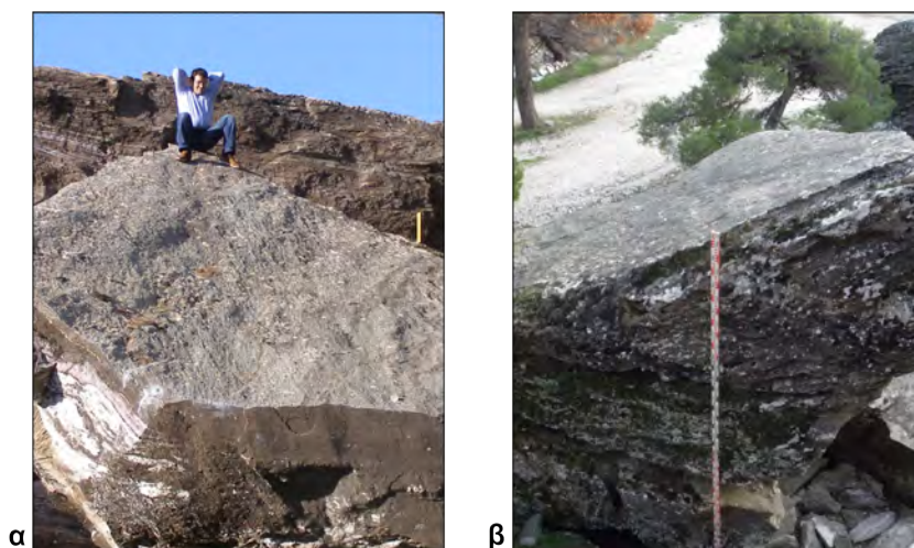
Σχήμα 7.2: Άποψη του βραχώδους όγκου που αποτέλεσε την επιφάνεια πρόσκρουσης: (α) από κατάντη και (β) πλησίον της θέσης που γίνονταν οι ρίψεις
