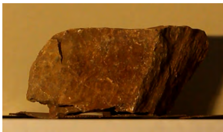
Σχήμα 6.2: Άποψη του ασβεστολιθικού τεμάχους που χρησιμοποιήθηκε ως βάση πρόσκρουσης
