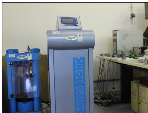
Σχήμα 4.17: Συσκευή προσδιορισμού της αντοχής του άρρηκτου πετρώματος (αριστερά) και σερβομηχανή για την επιβολή του φορτίου με σταθερό ρυθμό (δεξιά)
