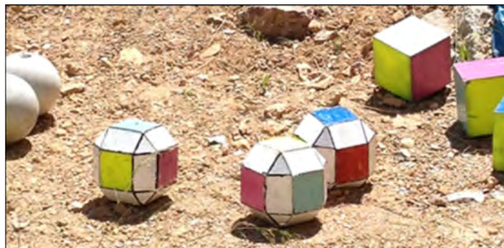
Σχήμα 7.13: Δοκίμια σφαιρικού, πολυεδρικού και κυβικού σχήματος
