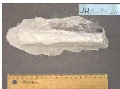
Εικόνα 3.16 Κονίαμα Πλήρωσης Ορθομαρμάρωσης (JHS_fe_m)
