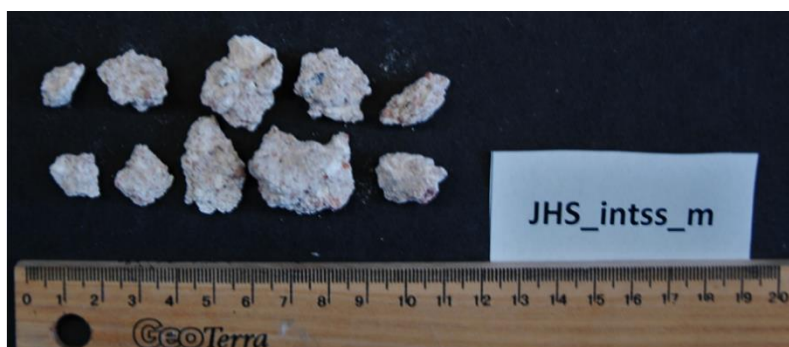
Εικόνα 3.17 Συνδετικό κονίαμα της εσωτερικής παρειάς της σκάλας (JHS_intss_m)
