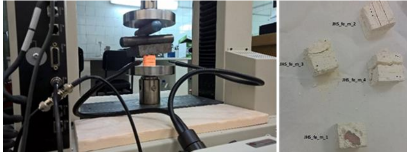
Εικόνα 3.52 Αριστερά : Πειραματική διάταξη κατά τη διάρκεια της μέτρησης ενός δοκιμίου του δείγματος κονιάματος πλήρωσης Δεξιά : Τα δοκίμια μετά από τις μετρήσεις
