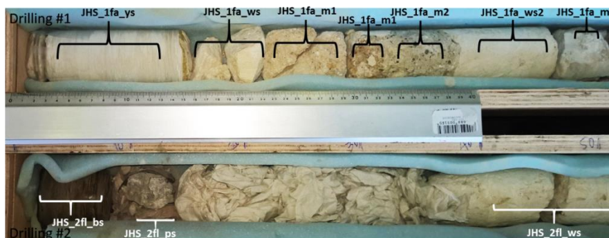
Εικόνα 3.14 Πάνω: Καρότο Τοιχοποιίας (drilling #1): Τρία δείγματα δομικών λίθων (JHS_1fa_ys, JHS_1fa_ws, JHS_1fa_ws2), Τρία δείγματα κονιαμάτων (JHS_1fa_m1, JHS_1fa_m2, JHS_1fa_m3) Κάτω: Καρότο Δαπέδου (drilling #2): Τρία δείγματα δομικών λίθων (JHS_2fl_bs, JHS_2fl_ps, JHS_2fl_ws)
