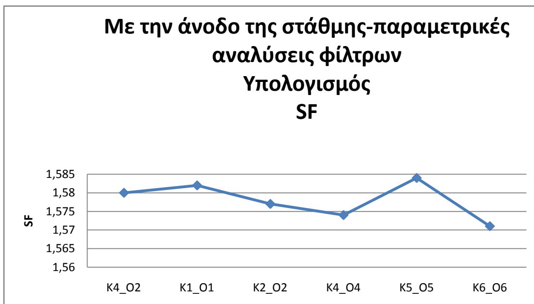
Εικόνα 5-23: Γραφική παράσταση του συντελεστή ασφαλείας, σε συνάρτηση με την αλλαγή του πάχους των φίλτρων
