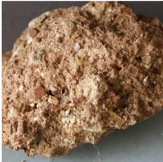
Εικόνα 30. Κονίαμα με σβώλους και λεπτό κεραμικό.
