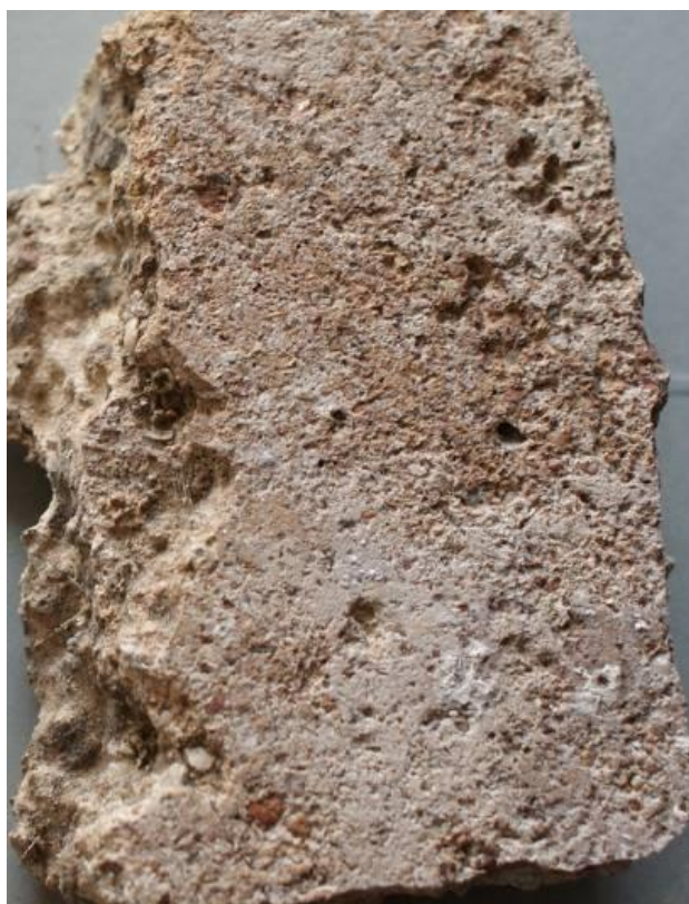
Εικόνα 34. Επίχρισμα με θρ. κεραμικό.
