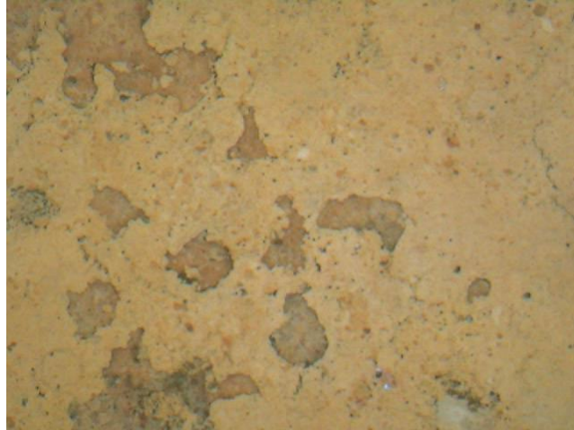
Εικόνα 37. RBR_3_PL. Επιφανειακές επικαθήσεις. (FOM, x30)
