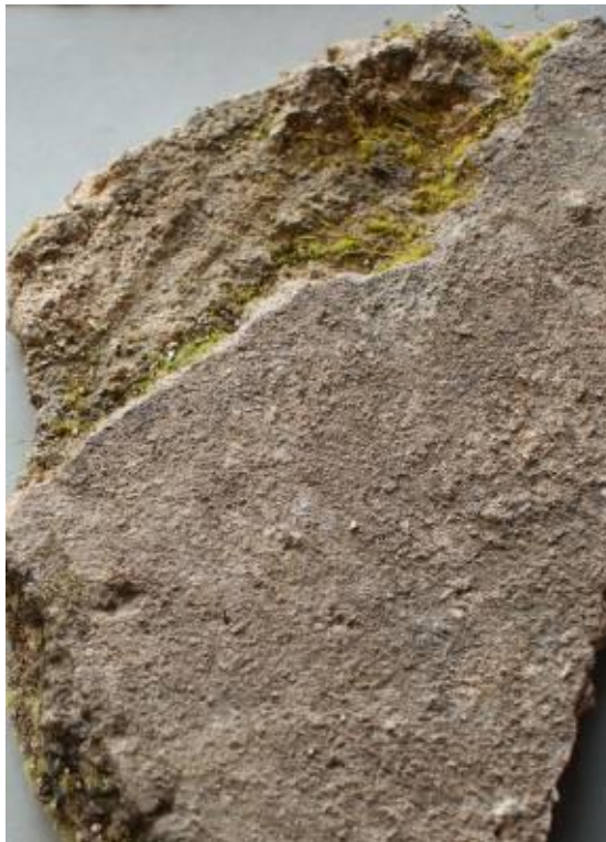
Εικόνα 32. Επίχρισμα με βιολογικές επικαθήσεις.
