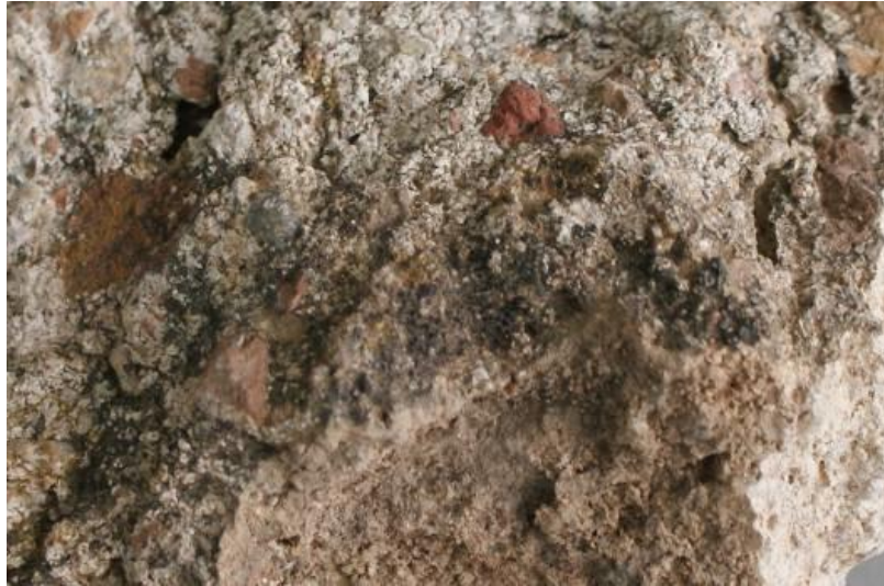
Εικόνα 31. Κονίαμα με χονδρό κεραμικό και βιολογικές επικαθήσεις
