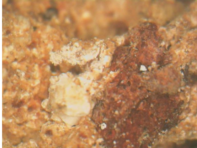
Εικόνα 42. RBR_10_MR. Λεπτό και χονδρό θρ. κεραμικό(FOM, x50)
