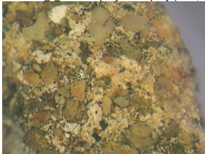
Εικόνα 47. RBR_1_PL. Βιολογικές επικαθήσεις. (FOM, x30rol)
