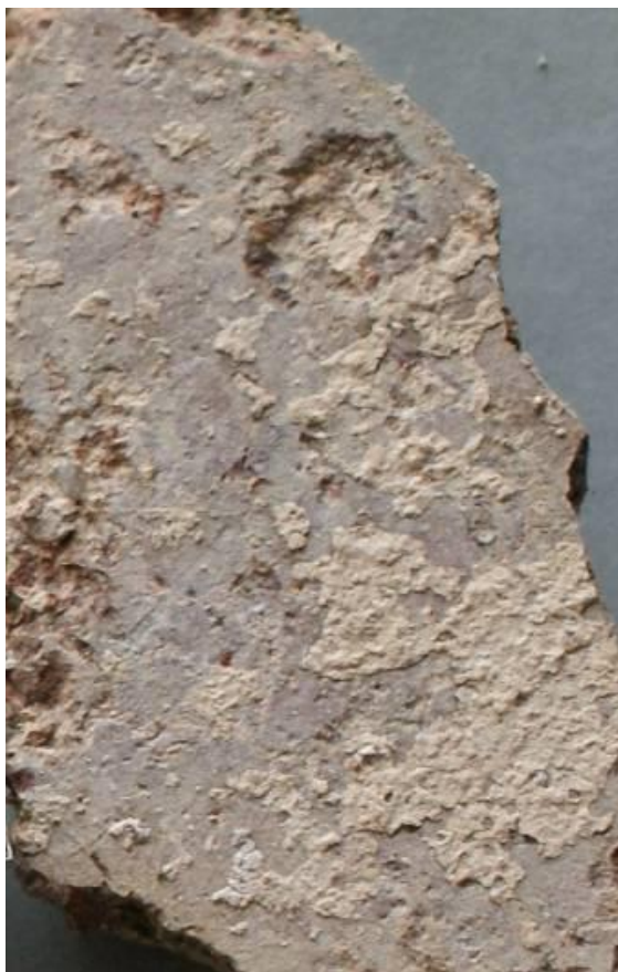
Εικόνα 34. Επίχρισμα με θρ. κεραμικό.
