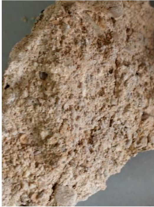
Εικόνα 29. Κονίαμα με εμφανή τα αδρανή
