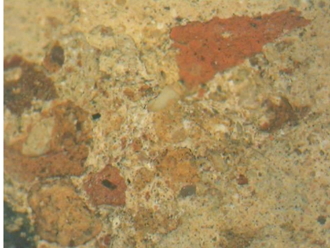
Εικόνα 39. RBR_3_PL. Αδρανή. (FOM, x30pol)
