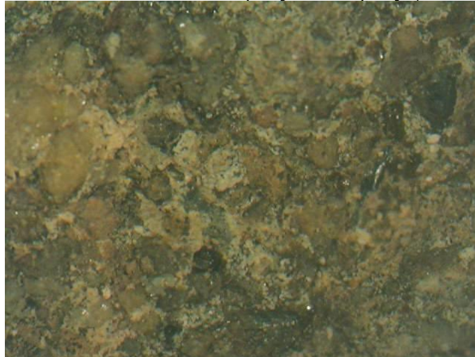
Εικόνα 43. RBR_1_PL. Βιολογικές επικαθήσεις. (FOM, x30)
