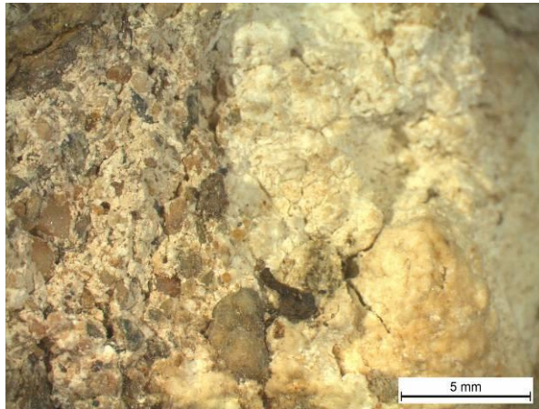
Εικόνα 49. RBR_5_PL. Είδη αδρανών. (FOM, x50)
