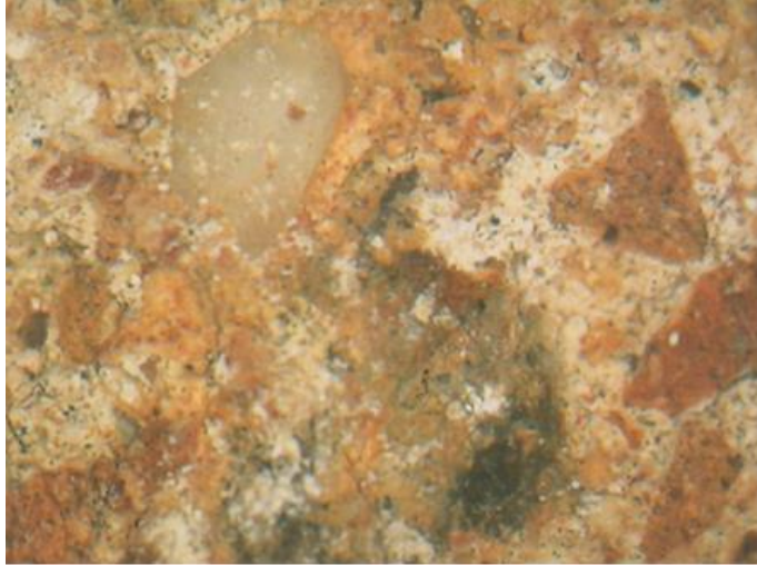
Εικόνα 36. RBR_1_PL. Κονία και αδρανή. (FOM, x50)
