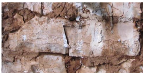
Εικόνες 8.31 και 8.32. Αριστερά(8.31)_ Μεγάλου εύρους ρωγμή στο κέντρο με φορά από κάτω προς τα πάνω και σχηματισμός ρωγμών από πάνω προς τα κάτω στο δεξιό τμήμα. Δεξιά (8.32)_ Κατακόρυφη ρωγμή από κάτω προς τα πάνω στο κέντρο του λίθου για χαμηλή φόρτιση.
