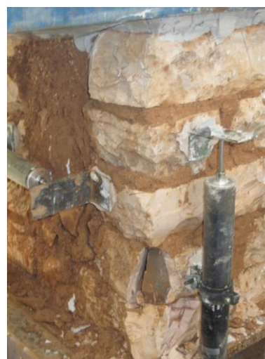
Εικόνες 8.26 και 8.27: Σύνθλιψη λίθου πρώτης στρώσης και αποκόλληση τμήματος του υπερκείμενου λίθου.
