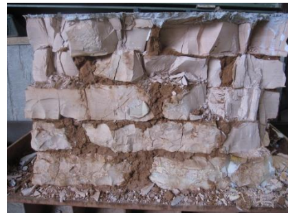
Εικόνες 8.21 και 8.22: εικόνα αστοχίας_ Αριστερά (8.21) πλευράς Π2 με κατακόρυφες ρωγμές στο σύνολο των λίθων και Δεξιά (8.22) πλευράς Π1 με σύνθλιψη λίθων.
