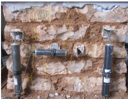
Εικόνες 8.24 και 8.25: λίγο πριν την αστοχία. Αριστερά(8.24) η Π1, δεξιά(8.25) η Π2
