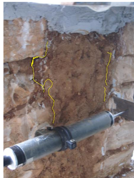
Εικόνες 8.13 και 8.14: Αριστερά(8.13)_ εμφάνιση πρώτης ρωγμής. Δεξιά(8.14)_ εμφάνιση ρωγμών αποκόλλησης.
