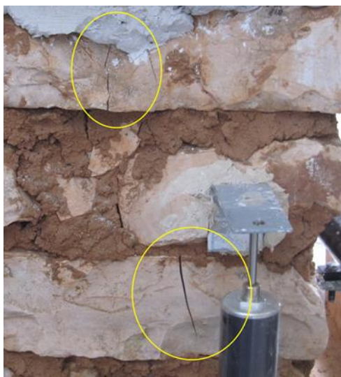
Εικόνες 8.29 και 8.30. Αριστερά(8.29)_ Ρωγμή στο κέντρο του λίθου της πάνω στρώσης με φορά από κάτω προς τα πάνω (ομοιότητα με αμφιέρειστο στοιχείο) και ρωγμή στο δεξιό τμήμα του λίθου της τρίτης στρώσης με φορά από πάνω προς τα κάτω (ομοιότητα με προβολικό στοιχείο).
