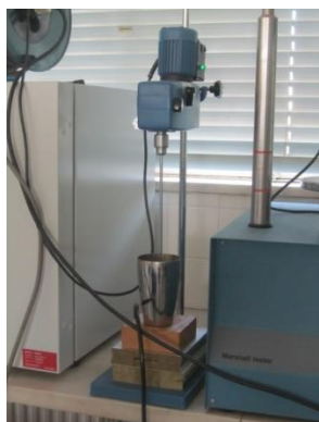
Εικόνα 4.1: Αριστερά: ηλεκτρικός αναμεικτης. Δεξιά: κύλινδρος Βουγιούκου με πυκνόμετρο εντός
