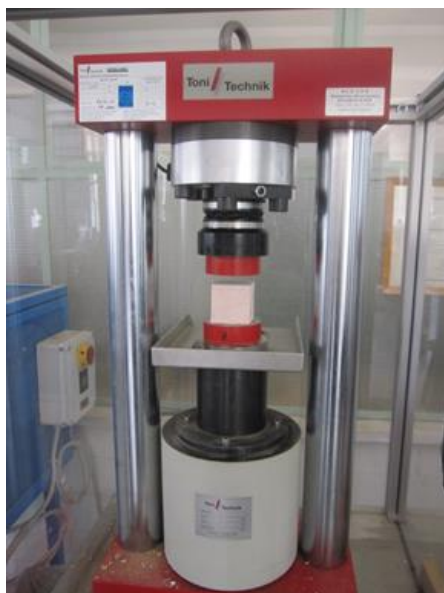
Εικόνα 4.7: Συσκευή προσδιορισμού θλιπτικής αντοχής δοκιμίου λίθου διαστάσεων 5cm*5cm*5cm
