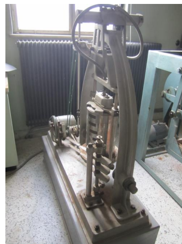
Εικόνα 4.4: Σειρά κοσκίνων και συσκευή κοσκίνισματος
