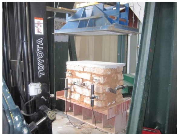
Εικόνα 8.12: Τοποθέτηση μεταλλικής πλάκας με χρήση αλφαδιού πάνω στο γυψοκονίαμα. Θέσεις μηκυνσιόμετρων.
