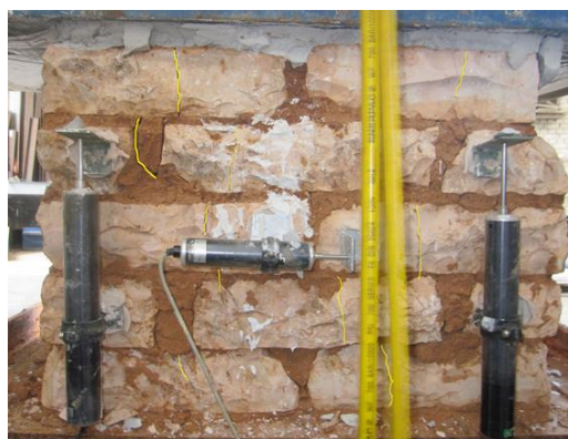
Εικόνες 8.24 και 8.25: λίγο πριν την αστοχία. Αριστερά(8.24) η Π1, δεξιά(8.25) η Π2
