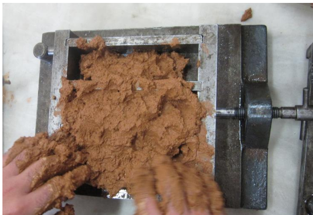
Εικόνα6.6: Παρασκευή δοκιμίων διαστάσεων 4 cm*4 cm*16 cm
