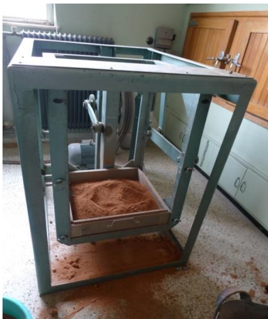
Εικόνα 6.3: κοσκίνισμα θρυμματισμένου χώματος
