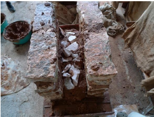
Εικόνες 8.7 και 8.8: Αριστερά(8.7)_ Στρώσεις κονιάματος και λίθων στην εσωτερική στρώση. Δεξιά(8.8)_ Το δοκίμιο ολοκληρωμένο
