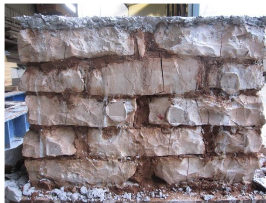
Εικόνες 8.17 και 8.18: Αριστερά(8.17)_ ρωγμές αποκόλλησης των στρώσεων που διέρχονται και από τους λίθους με ταυτόχρονο φούσκωμα. Δεξιά(8.18)_ Μορφή αστοχίας πίσω στρώση.
