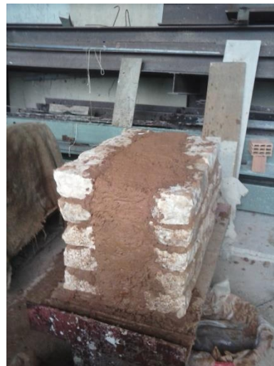
Εικόνες 8.9 και 8.10: Αριστερά(8.9)_ Εξωτερικές στρώσεις που μόλις έχουν τελειώσει. Δεξιά(8.10)_ Η εσωτερική στρώση που μόλις έχει τελειώσει.
