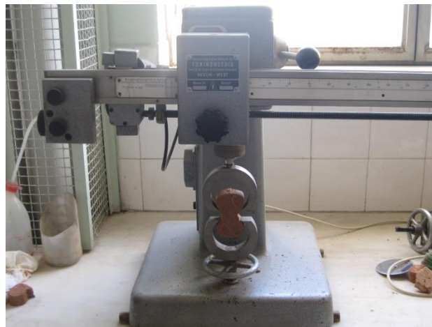
Εικόνα 4.5: Συσκευή μέτρησης εφελκυστικής αντοχής κονιάματος.
