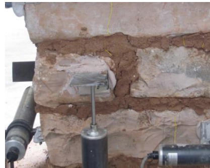
Εικόνες 8.19 και 8.20: εμφάνιση ρωγμών Αριστερά (8.19) στην πλευρά Π1 και Δεξιά (8.20) στην Π2
