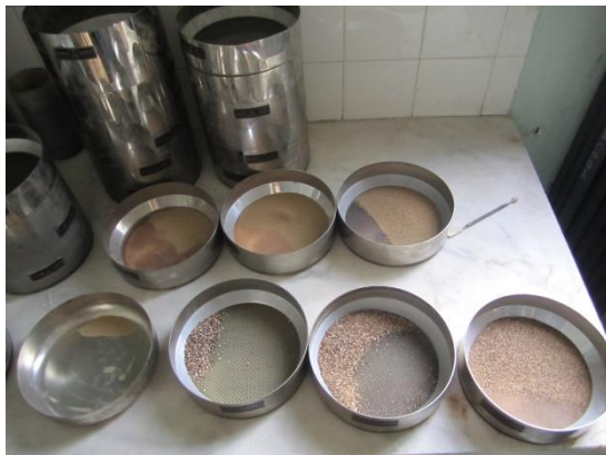
Εικόνα 4.4: Σειρά κοσκίνων και συσκευή κοσκίνισματος
