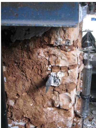
Εικόνες 8.17 και 8.18: Αριστερά(8.17)_ ρωγμές αποκόλλησης των στρώσεων που διέρχονται και από τους λίθους με ταυτόχρονο φούσκωμα. Δεξιά(8.18)_ Μορφή αστοχίας πίσω στρώση.
