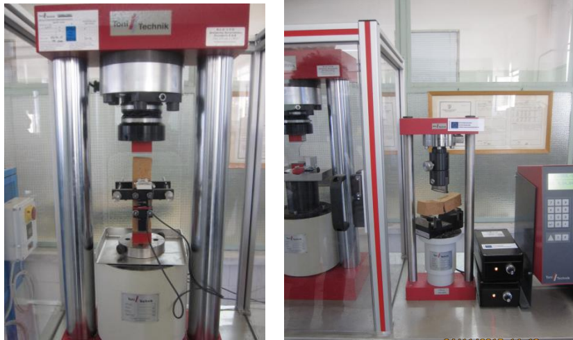
Εικόνα 4.6: Αριστερά: Συσκευή μέτρησης θλιπτικής αντοχής και μέτρου ελαστικότητας. Δεξιά: Συσκευή μέτρησης καμπτικής αντοχής.
