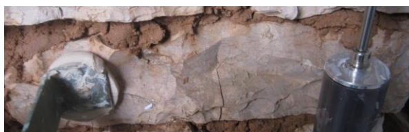
Εικόνες 8.31 και 8.32. Αριστερά(8.31)_ Μεγάλου εύρους ρωγμή στο κέντρο με φορά από κάτω προς τα πάνω και σχηματισμός ρωγμών από πάνω προς τα κάτω στο δεξιό τμήμα. Δεξιά (8.32)_ Κατακόρυφη ρωγμή από κάτω προς τα πάνω στο κέντρο του λίθου για χαμηλή φόρτιση.
