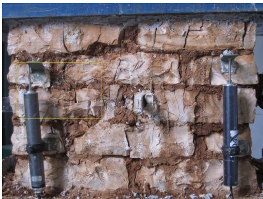
Εικόνες 8.15 και 8.16: Αριστερά(8.15)_μορφή αστοχίας μπροστά στρώση. Δεξιά(8.16) _λεπτομέρεια θρυμματισμού αριστερού λίθου.
