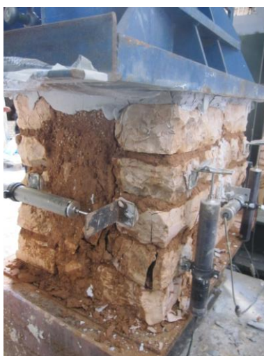
Εικόνες 8.26 και 8.27: Σύνθλιψη λίθου πρώτης στρώσης και αποκόλληση τμήματος του υπερκείμενου λίθου.
