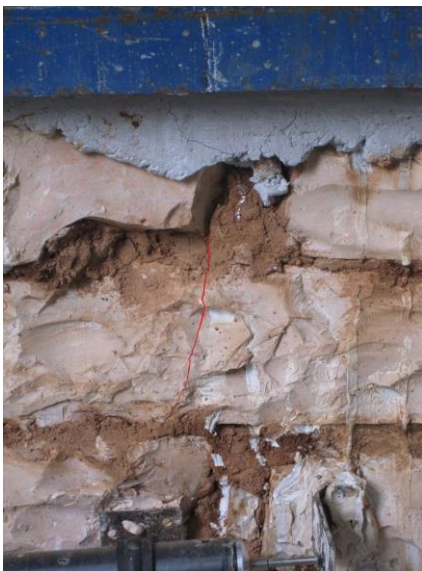
Εικόνες 8.13 και 8.14: Αριστερά(8.13)_ εμφάνιση πρώτης ρωγμής. Δεξιά(8.14)_ εμφάνιση ρωγμών αποκόλλησης.
