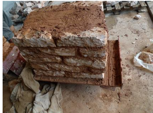
Εικόνες 8.7 και 8.8: Αριστερά(8.7)_ Στρώσεις κονιάματος και λίθων στην εσωτερική στρώση. Δεξιά(8.8)_ Το δοκίμιο ολοκληρωμένο
