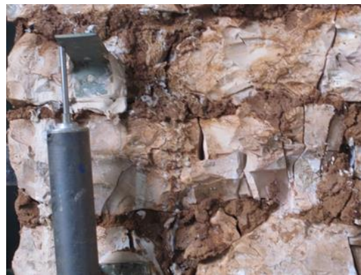
Εικόνες 8.15 και 8.16: Αριστερά(8.15)_μορφή αστοχίας μπροστά στρώση. Δεξιά(8.16) _λεπτομέρεια θρυμματισμού αριστερού λίθου.
