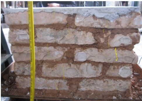
Εικόνες 8.21 και 8.22: εικόνα αστοχίας_ Αριστερά (8.21) πλευράς Π2 με κατακόρυφες ρωγμές στο σύνολο των λίθων και Δεξιά (8.22) πλευράς Π1 με σύνθλιψη λίθων.
