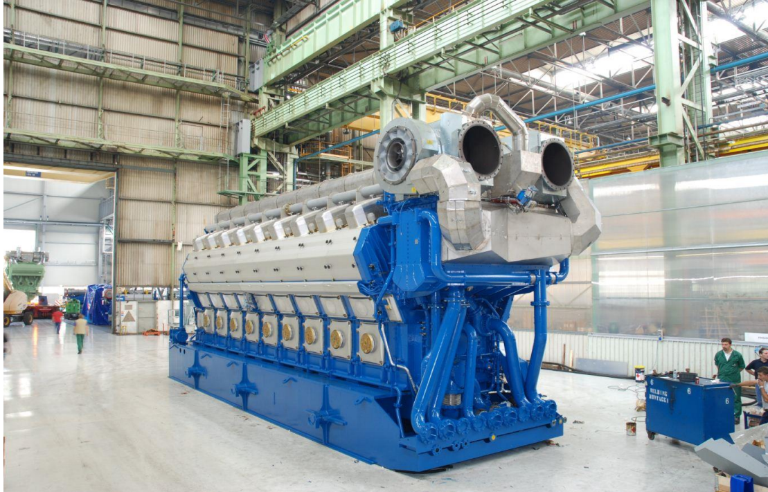
ΕΙΚΟΝΑ 13 – DUAL FUEL ENGINE (DF), ΠΗΓΗ: WARTSILA
