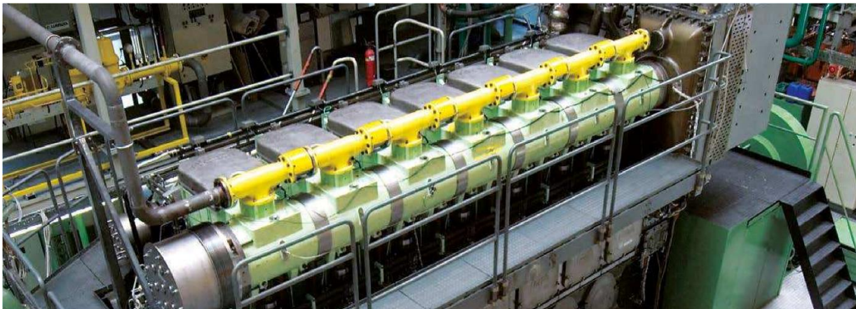
ΕΙΚΟΝΑ 6: ΚΙΝΗΤΗΡΑΣ ΦΥΣΙΚΟΥ ΑΕΡΙΟΥ ΤΟΥ RO-PAX FERRY «GLUTRA», ΠΗΓΗ: [24]
