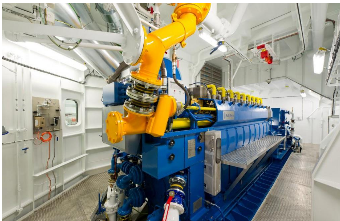
ΕΙΚΟΝΑ 10 – ΝΑΥΤΙΚΟΣ ΚΙΝΗΤΗΡΑΣ ΦΥΣΙΚΟΥ ΑΕΡΙΟΥ (LEAN BURN SPARK IGNITED) – ΠΗΓΗ: ROLLS – ROYCE, 2012
