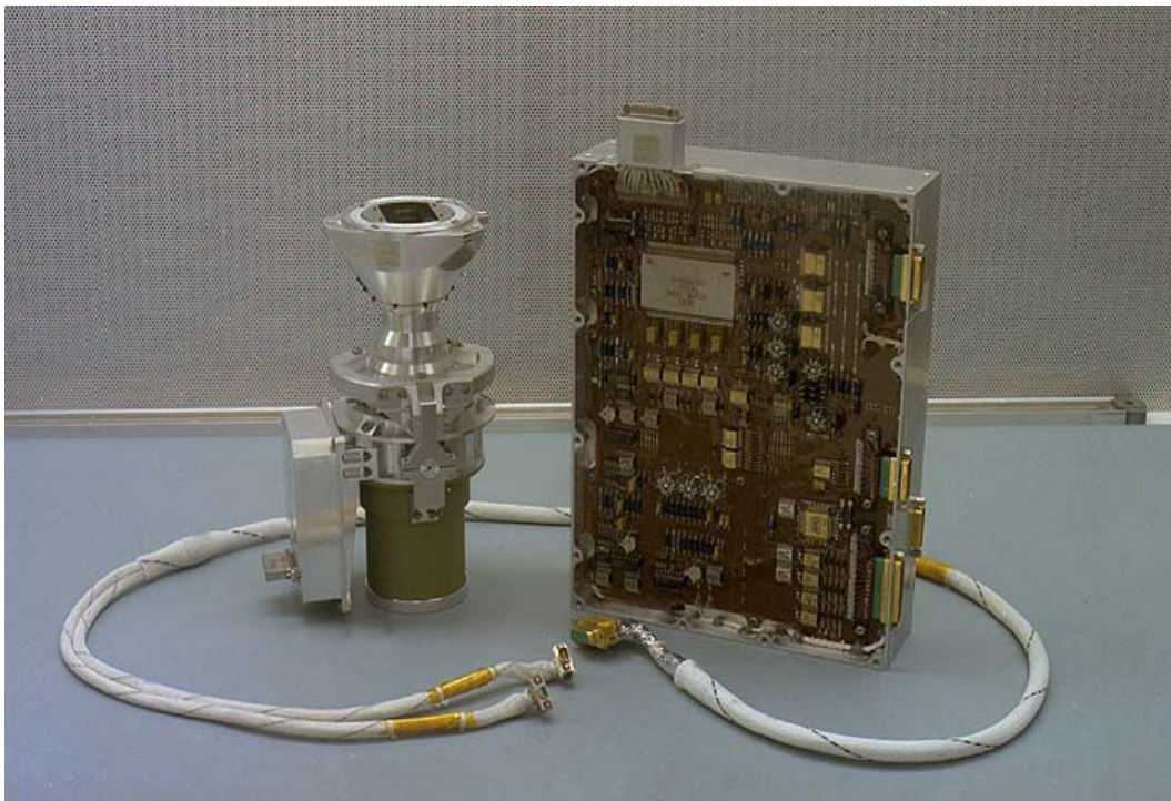
Εικόνα 2.5 Μία από τις 9 κάμερες του MISR πλήρως συναρμολογημένη, σε συνδυασμό με τα ηλεκτρονικά στοιχεία στήριξης. Κάθε μηχανή είναι μια αυτοδύναμη μονάδα σχεδιασμένη ώστε να δοκιμαστεί και να βαθμονομηθεί ανεξάρτητα προτού προστεθεί στο συγκρότημα στήριξης του MISR ή στον οπτικό πάγκο. Η κάμερα της φωτογραφίας είναι μία από τις "A" κάμερες του οργάνου, οι οποίες έχουν τα μικρότερα τηλεσκόπια. ( www-misr.jpl.nasa.gov/misrInstrument )
