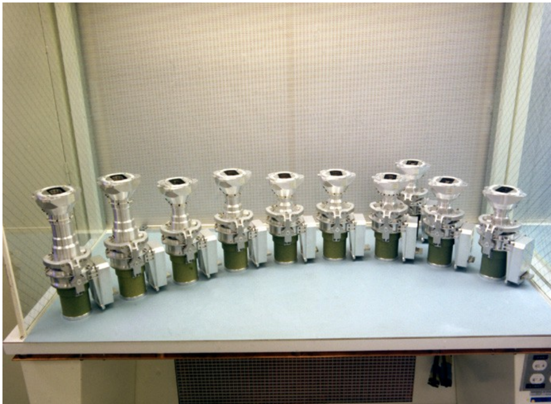
Εικόνα 2.4 Οι εννέα κάμερες του MISR, καθώς και τρεις ανταλλακτικές κάμερες, το 1996, πριν συνδεθούν με το όργανο MISR. Οι δύο κάμερες που έχουν σχεδιαστεί για να σαρώνουν τις μεγαλύτερες γωνίες, οι οποίες είναι γνωστές ως Da/Df έχουν τα μεγαλύτερα τηλεσκόπια. Μία από τις ανταλλακτικές κάμερες χρησιμοποιήθηκε για την κατασκευή του AirMISR, ενός οργάνου που έχει σχεδιαστεί για να λειτουργεί σε αεροπλάνο, για να ελέγξει τα δεδομένα από το όργανο του διαστημόπλοιο (Diner et al., 1998).
