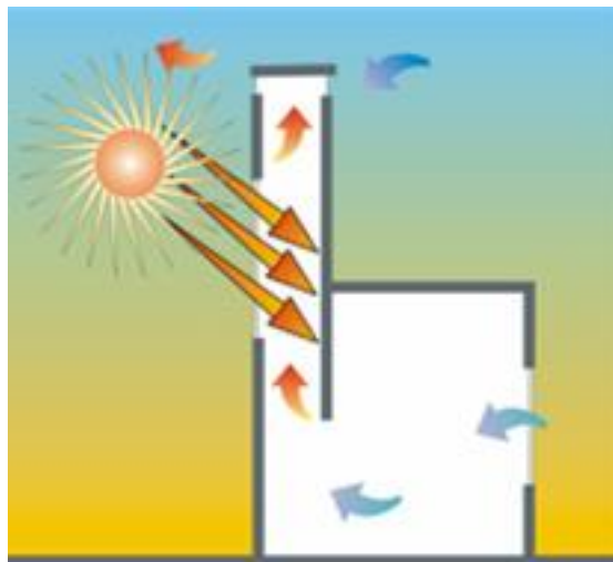
Εικόνα 1.10: Φυσικός αερισμός μέσω ηλιακής καμινάδας[24]
