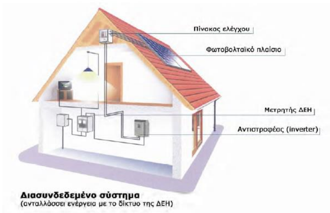
Εικόνα 4.27: Διασυνδεδεμένο σύστημα φωτοβολταϊκών σε οικία [33]
