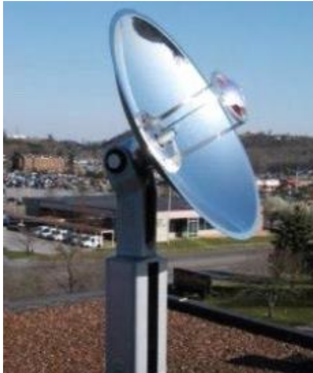
Εικόνα 1.26: Σύστημα κατόπτρων και φακών για τη συλλογή φωτός[30]
